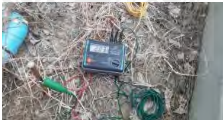
รูปที่ 4.35 การทดลองระบบกราวด์
