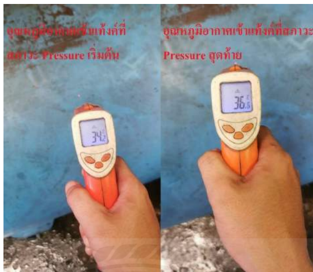
รูปที่ 4.11 การวัดค่าครั้งที่ 1 อุณหภูมิเข้าแท้งค์ Pressure เริ่มต้น และ อุณหภูมิเข้าแท้งค์ Pressure สุดท้าย
