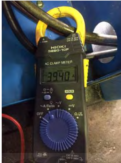
รูปที่ 4.17 วัดค่าการกินกระแส ขณะโหลดของเครื่องอัดอากาศ
