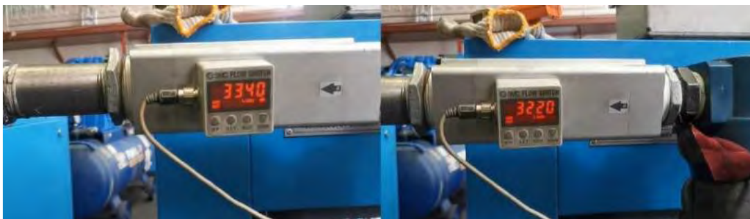
รูปที่ 4.18 วัดอัตราการไหลโดยใช้เครื่องมือวัด
