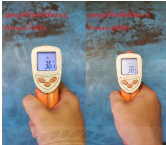
รูปที่ 4.13 การวัดค่าครั้งที่ 2 อุณหภูมิเข้าแท่ง Pressure เริ่มต้น และ อุณหภูมิเข้าแท่ง Pressure สุดท้าย
