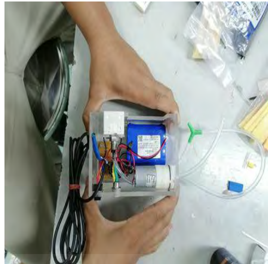
รูปที่ 3.8 ต่อสายยางเข้ากับปั๊มสุญญากาศและเซ็นเซอร์
