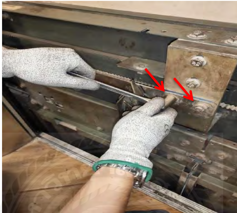
รูปที่ 3.23 ถอดรางลูกส้อชุดแคมป์ออก
