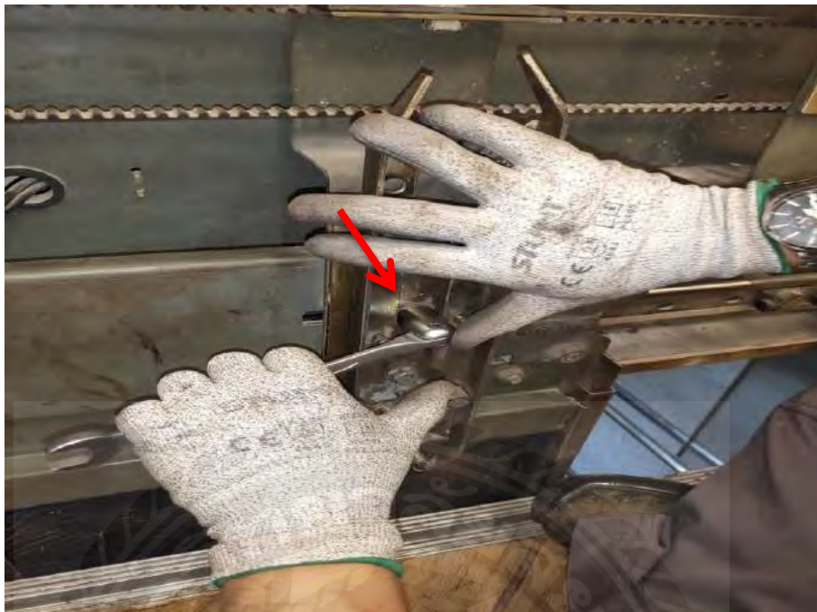
รูปที่ 3.27(A) ขั้นตอนการถอดน็อตยึดชุดแคมป์ประตู่และนำออกเปลี่ยนใหม่
