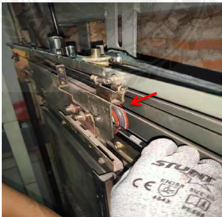
รูปที่ 3.18 นำไขควงปากแบนดันลูกล้อออก
