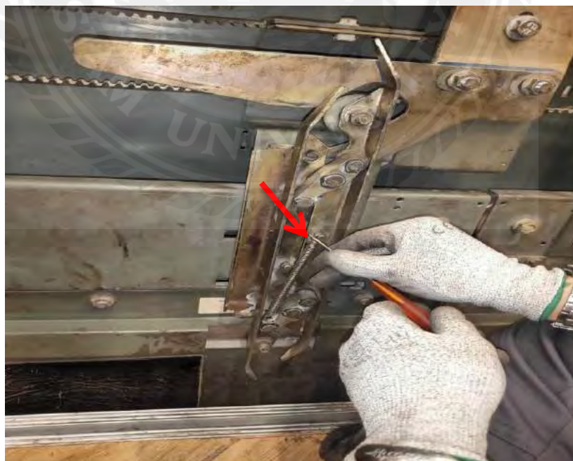
รูปที่ 3.24 ถอดสลึงยึดก้านแคมป์ออก
