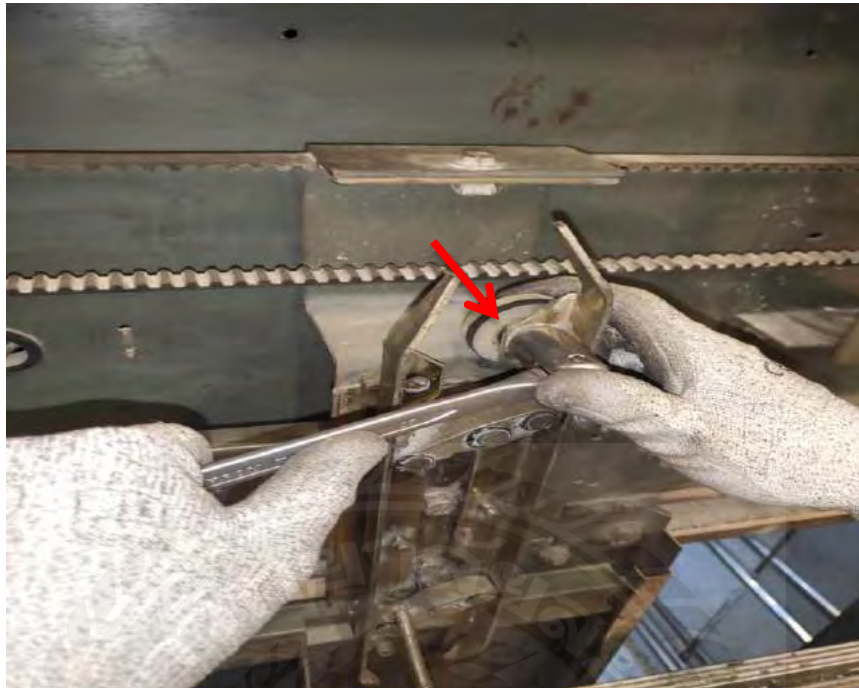
รูปที่ 3.25 ขั้นตอนการถอดลูกล้อยึดแคมป์ประตู
