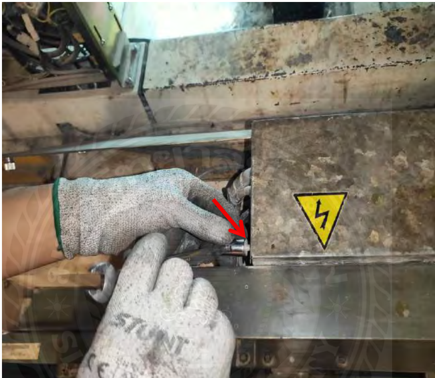
รูปที่ 3.20 การถอดฝาครอบมอเตอร์ประตู
