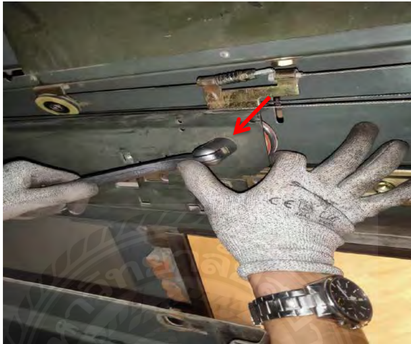
รูปที่ 3.12(A) การถอดลูกถ้วยประตูและนำออกเปลี่ยนใหม่
