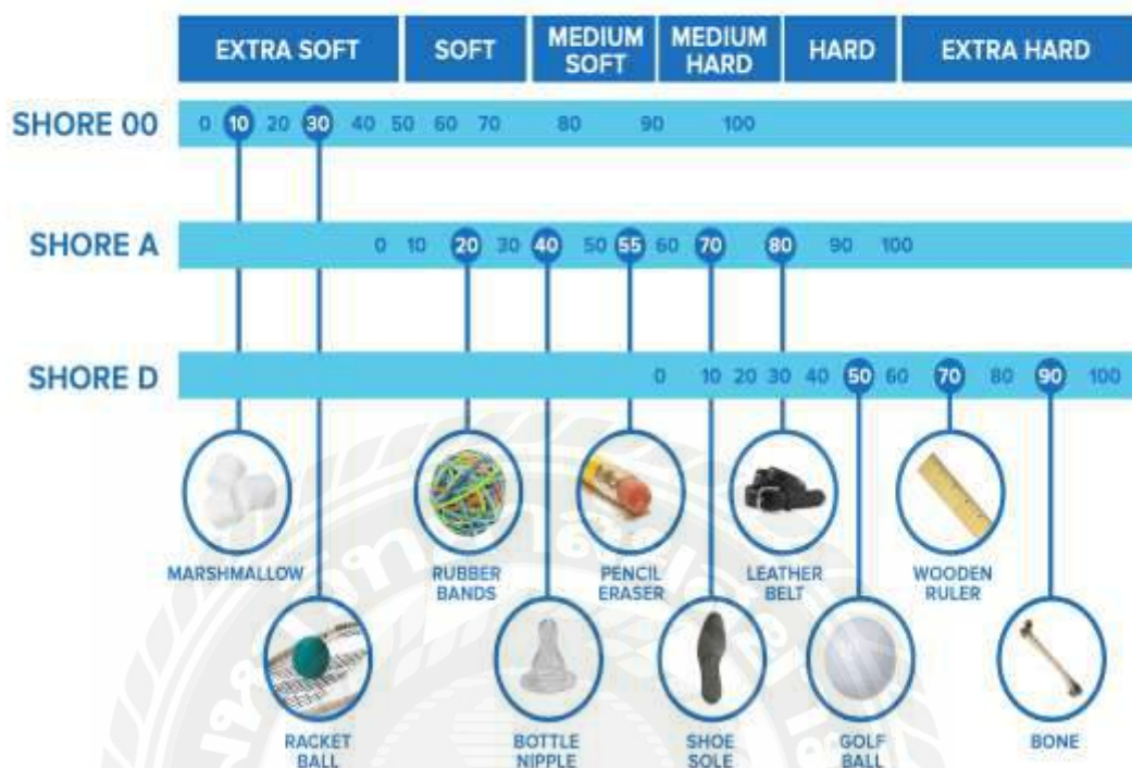
รูปที่ 2.6 ภาพ Shore Hardness Scale
