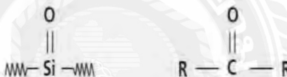
รูปที่ 2.2 โครงสร้างไซลอกเซน
