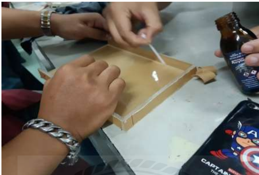
รูป ก. 3 ประกอบแม่พิมพ์ด้วยน้ำยาประสานอะคริลิก
