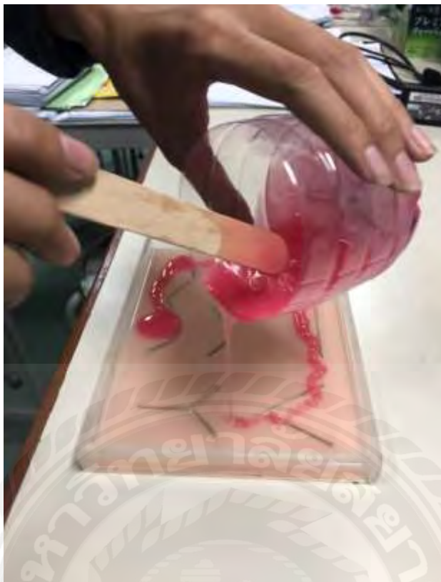
รูป ก. 5 ผสมยางซีลิกอนเทใส่แม่พิมพ์
