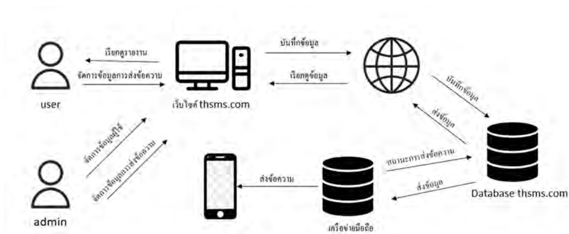
รูปที่ 2.1 โครงสร้างการทำงานของเว็บไซต์ส่งข้อความ SMS
