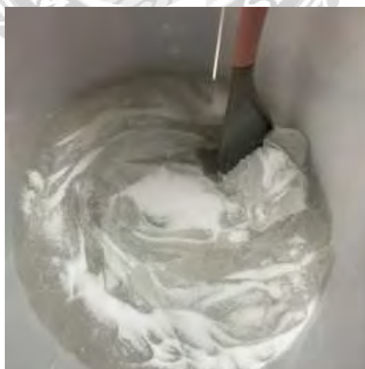
รูปที่ 4.8 ขั้นตอนการผสม หัวเชื้อทำความสะอาด (N70) และเกลือแกง
