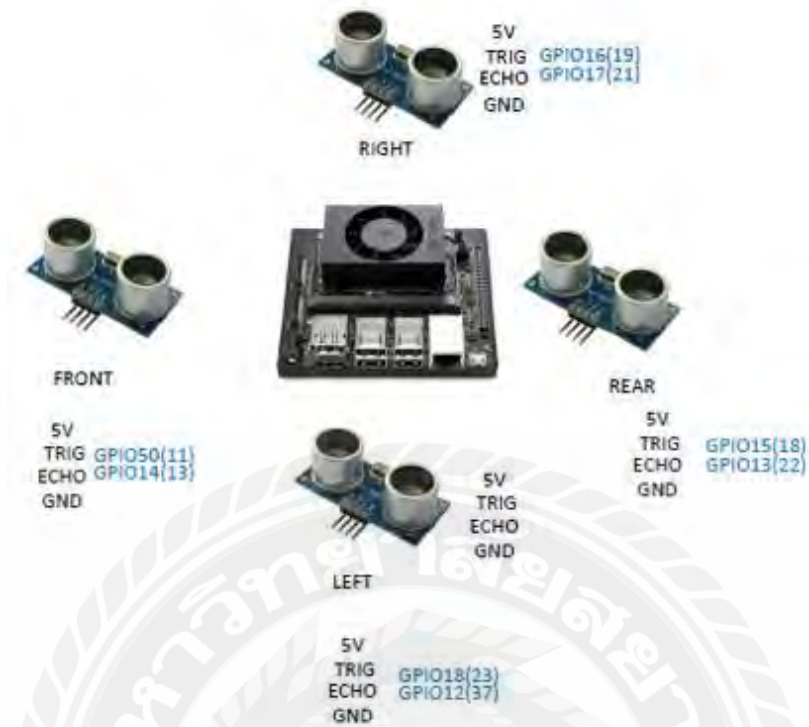
รูปที่ 3.11 เชื่อมสายจาก Ultrasonic เข้า Jetson Nano
