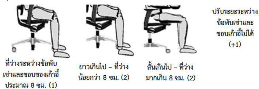
รูปที่ 3.13 แสดงลักษณะการประเมินความลึกของเก้าอี้ในวิธี ROSA
