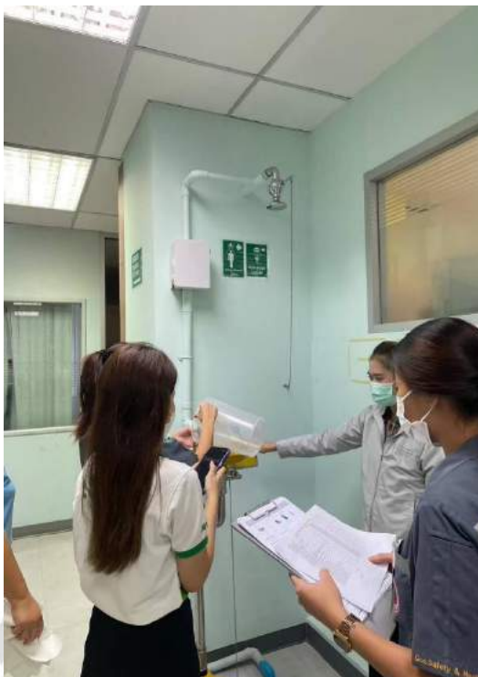
รูปที่ 3.5 การตรวจอัตราการไหลของฝักบัวฉุกเฉินและที่ล้างตาฉุกเฉิน
