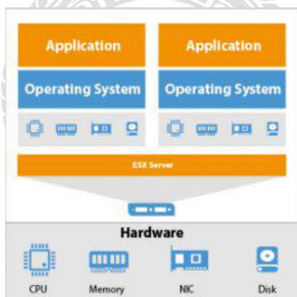
ภาพที่ 2.3 หลักการทำงานเครื่องเซิร์ฟเวอร์เสมือน
