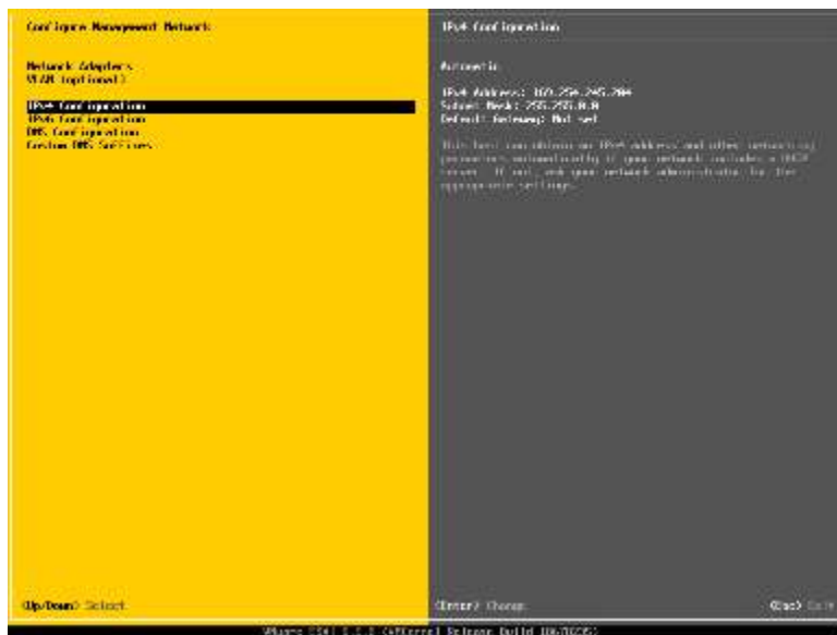
ภาพที่ 4.24 หน้าจอภายใน Configure Management Network เมื่อเข้ามาในตัวเลือก Configure Management Network แล้วให้กลุ่มลูกศรลงมาที่ตัวเลือก IPv4 Configuration เพื่อเข้าสู่การตั้งค่า IP Address
