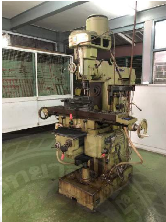
รูปที่ 3.3 เครื่องกัด Milling Machine รุ่น CLD-VHR-C
