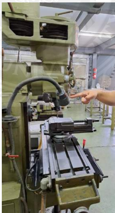
รูปที่ 3.9 ระบบไฟส่องสว่างชิ้นงาน
