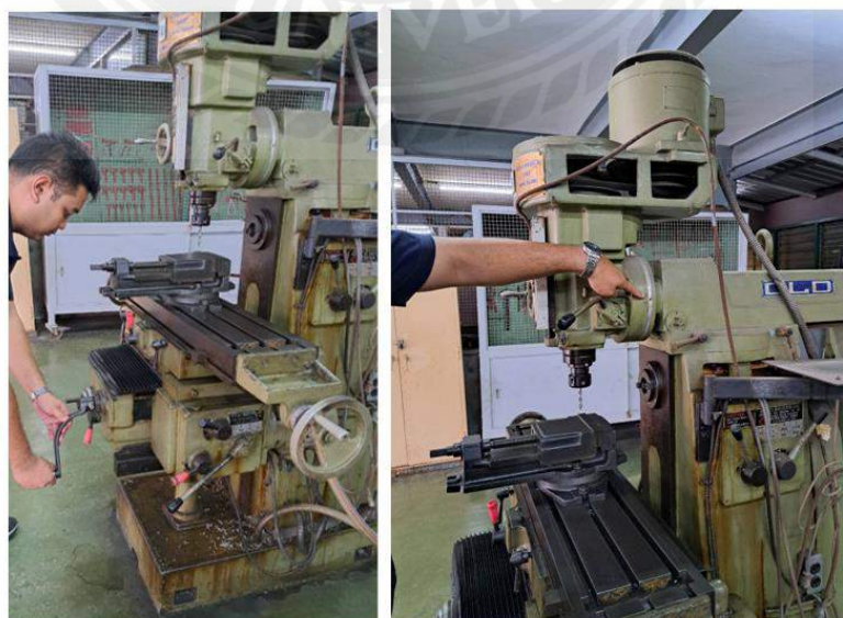
รูปที่ 3.15 แขนปรับระดับในแนวแกน Y และตัวหมุนปรับองศาหัวกัด
