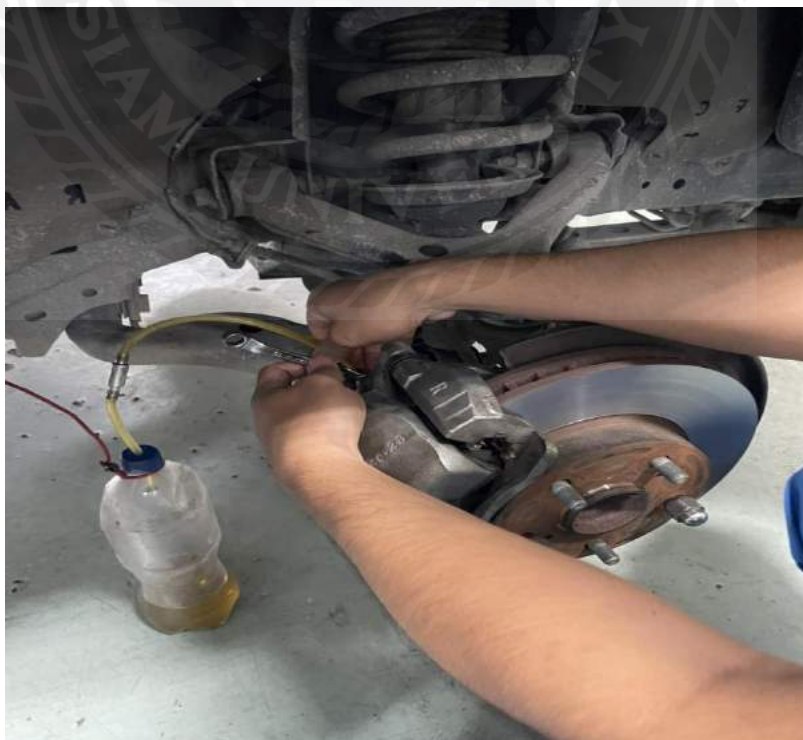
รูปที่ 3.48 ต่อท่ออย่างที่ติดตั้งวาล์วกันกลับเข้ากับปลั๊กไล่ลมและคลายปลั๊กไล่ลม
