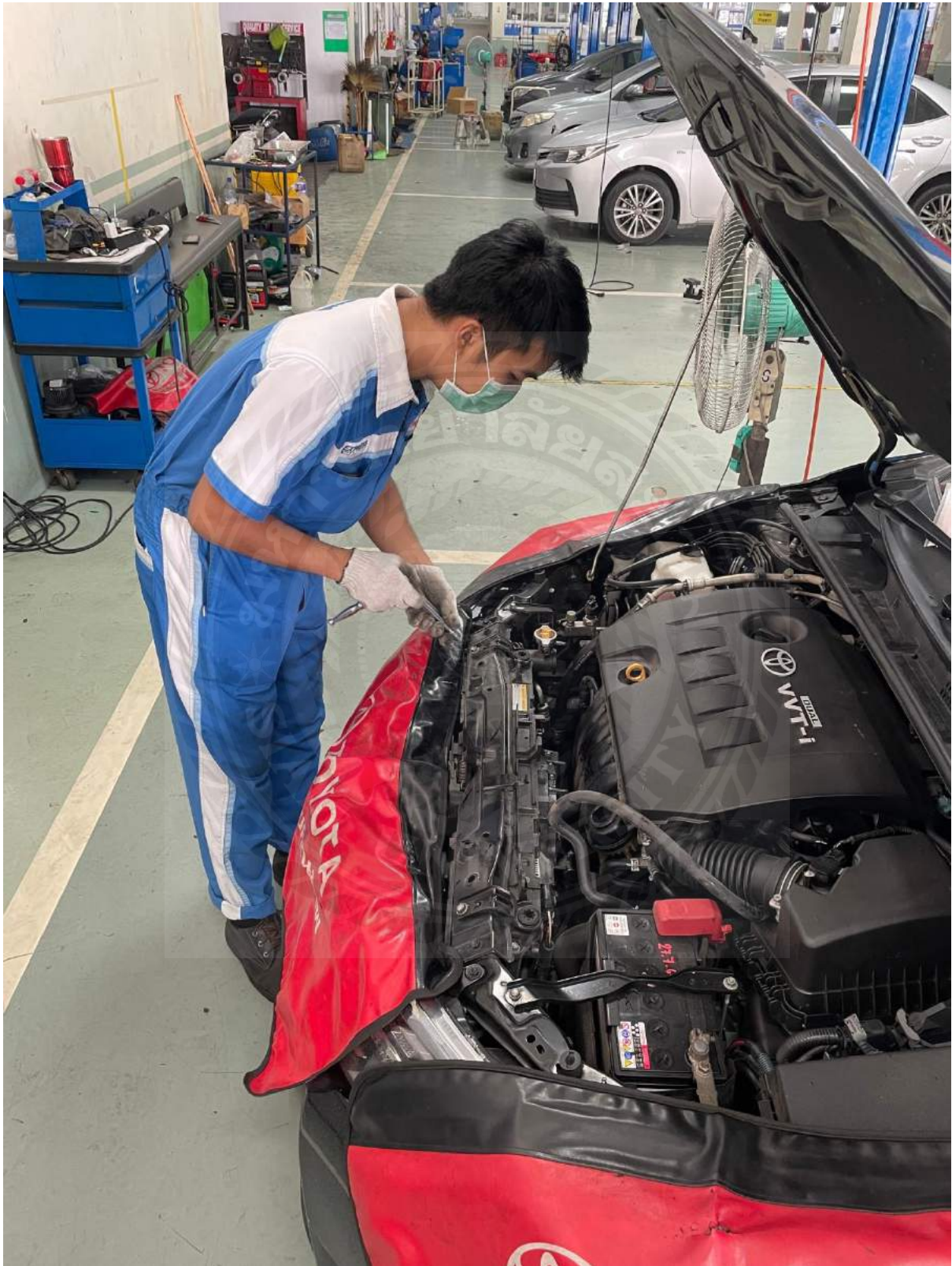
รูปที่ 1 การเปลี่ยนมอเตอร์พัดลม
