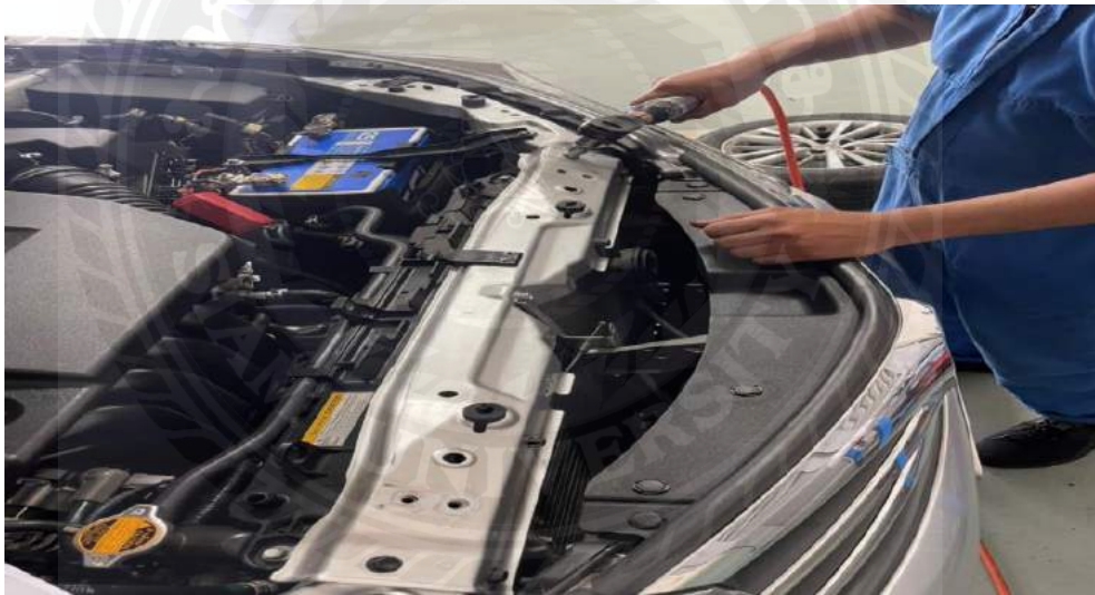
รูปที่ 3.31 ถอดชุดประกับยึดหมอน้ำตัวบน
