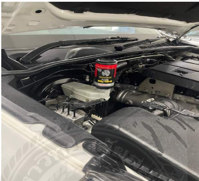
รูปที่ 3.47 เติมน้ำมันเบรกลงในกระปุกน้ำมันเบรก
