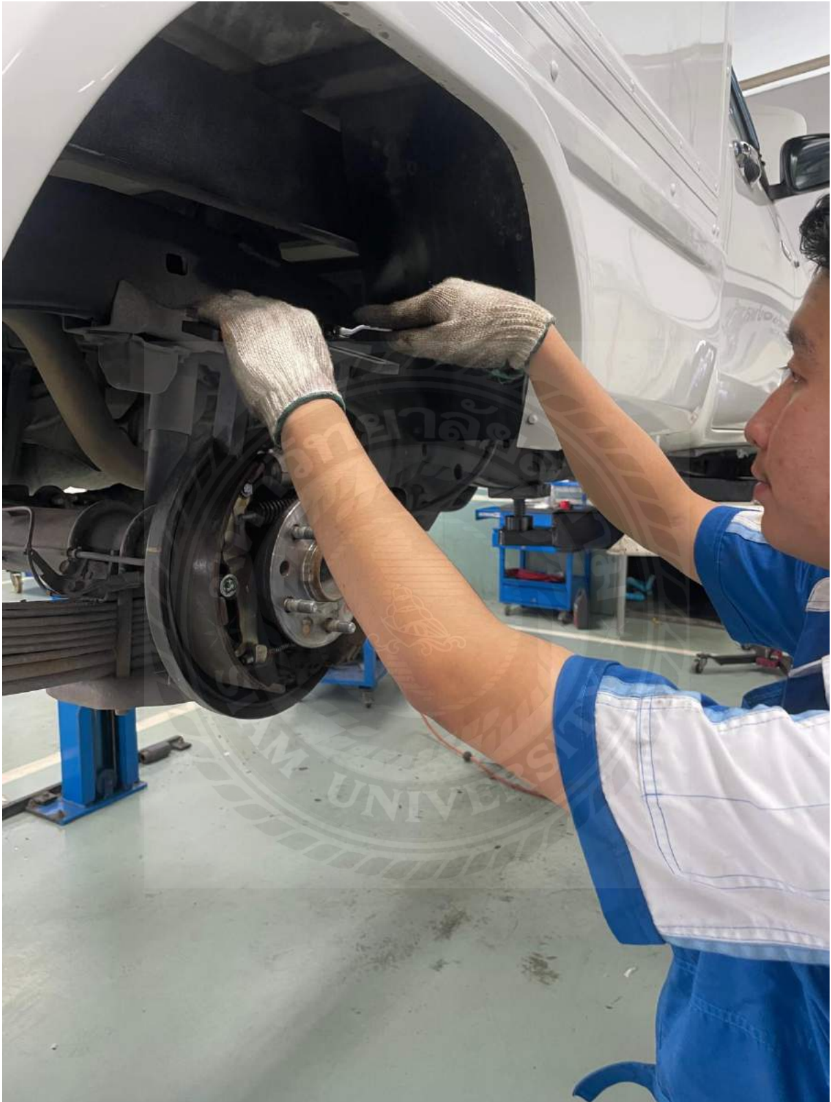
รูปที่ 2 การเปลี่ยนกระบอกเบรคหลัง
