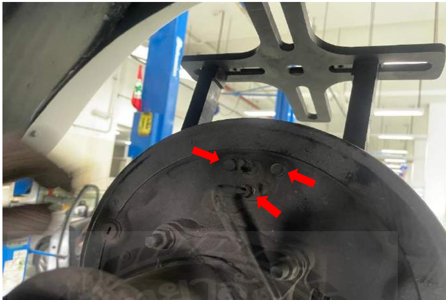
รูปที่ 3.42 โบลต์กระบอกเบรกและนัตปลายท่อน้ำมันเบรก
