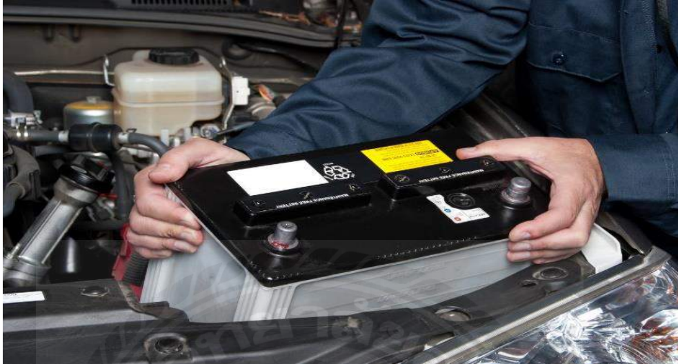
รูปที่ 3.28 ถอดแบตเตอรี่
