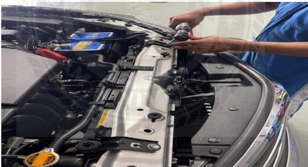
รูปที่ 3.29 ถอดประกับยึดหม้อน้ำตัวบน
