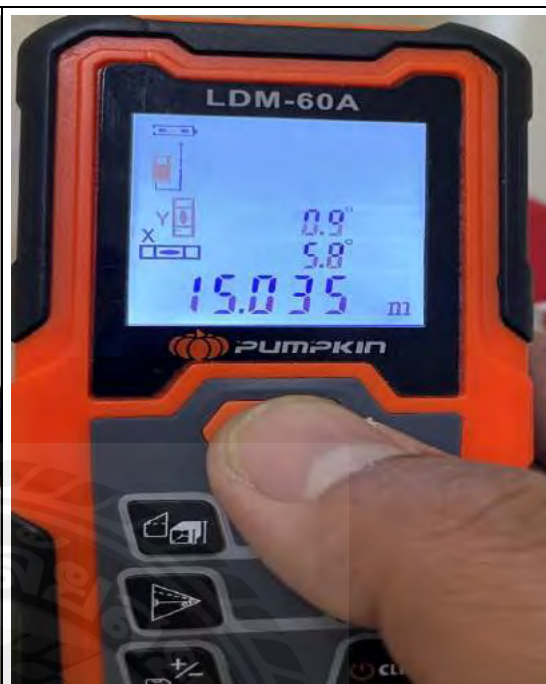
รูปภาพผนวก ที่ 51 ระยะห่างของถังดับเพลิงอยู่ที่ 15 เมตร
