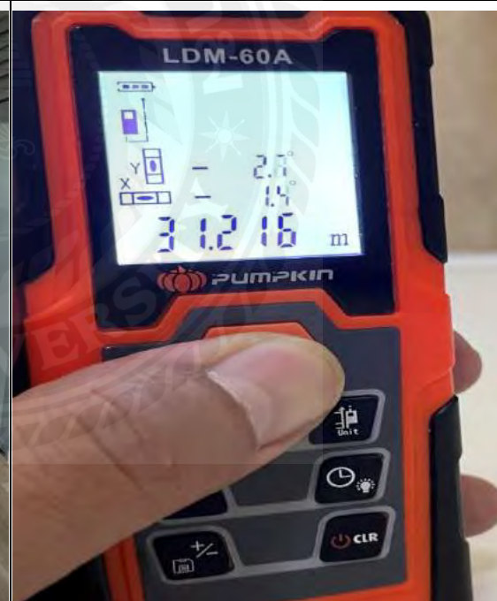
รูปภาพผนวก ที่ 8 ใช้อุปกรณ์เครื่องวัดระยะเลเซอร์วัดระยะห่าง จากบันไดที่ 1 ไปถึง บันไดที่ 2 ได้ 31.216 เมตร
