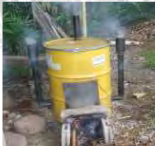
รูปที่ 4.1 ถัง 200 ลิตร สำหรับทำเตาเผา
