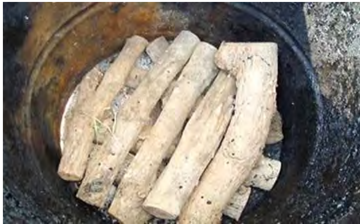
รูปที่ 4.8 การวางวัตถุดิบลงในเตาเผา
