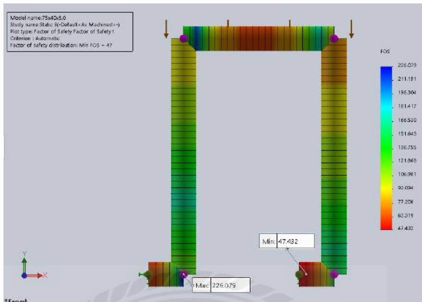
รูปที่ 4.19 ผลการจำลองของฐานรองรับท่อด้านน้ำเข้าปั้มดับเพลิงที่ออกแบบใหม่ C
