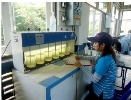
รูป 4.7 การทดสอบคุณภาพน้ำประปา
