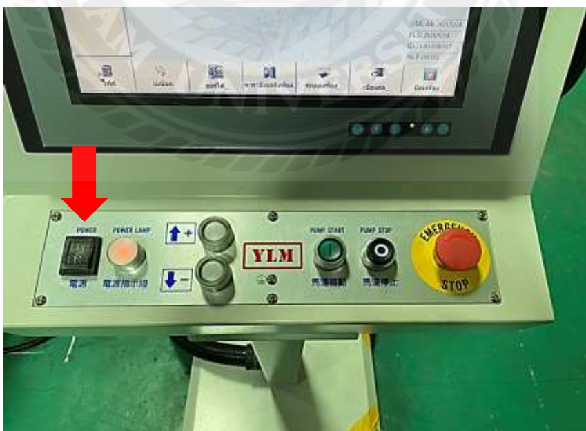
รูปที่ 3.6 แสดงถึงแผงควบคุมเครื่องตัดท่ออัตโนมัติ
