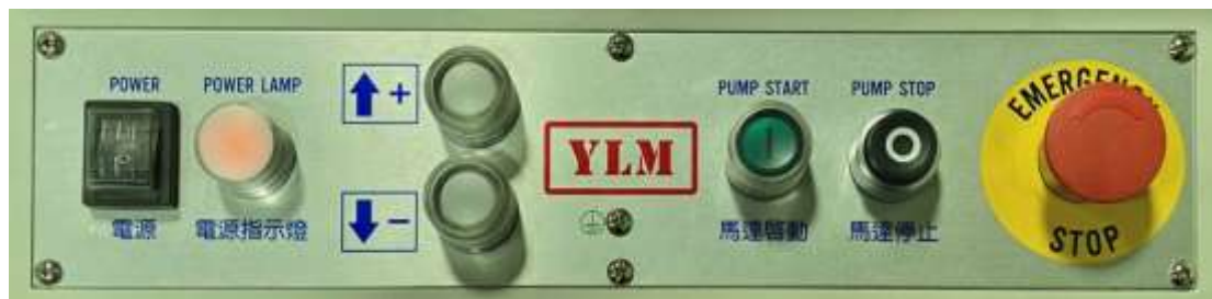
รูปที่ 2.10 แสดงถึงแผงควบคุมของเครื่องตัดท่ออัตโนมัติ
