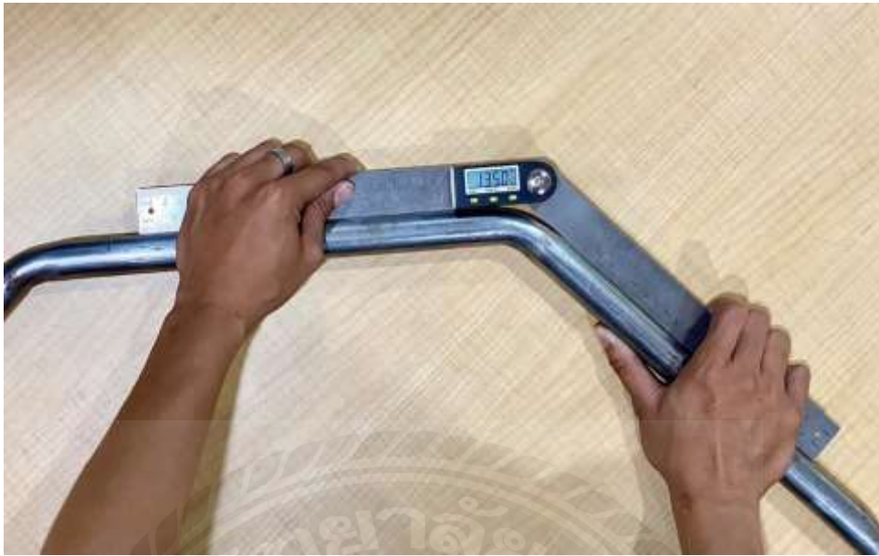
รูปที่ 4.4 แสดงถึงวิธีการวัดองศาที่ 45^{\circ}
