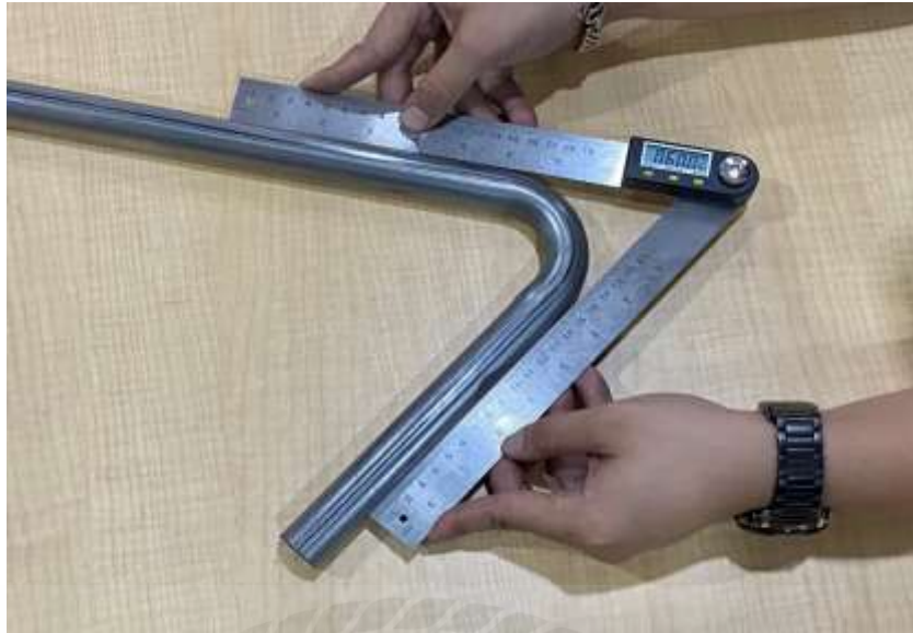
รูปที่ 3.16 แสดงถึงวิธีการวัดองศา
