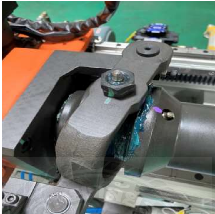
รูปภาคผนวก ข ที่ 3 แสดงถึงจุดอัดจาระบี ชั้นส่วนเคลื่อนที่
