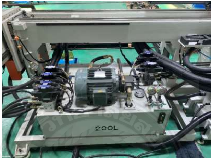
รูปภาพผนวก ข ที่ 5 แสดงถึงชุดปั๊ม Hydraulic ของเครื่องตัดท่ออัตโนมัติ
