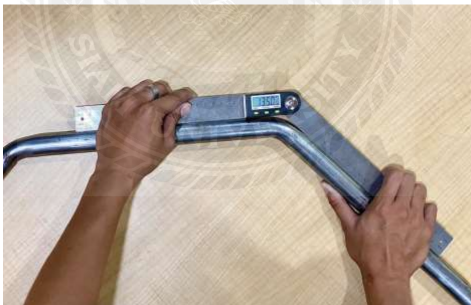
รูปที่ 3.14 แสดงถึงการตรวจสอบองศาการตัด
