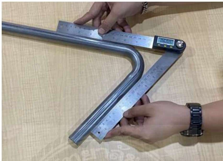
รูปที่ 4.6 แสดงถึงวิธีการวัดองศาที่ 120^{\circ}
