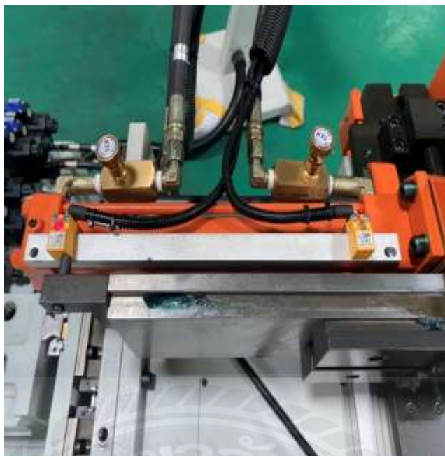
รูปภาคผนวก ข ที่ 9 Sensor ตรวจจับระยะ hydraulic
