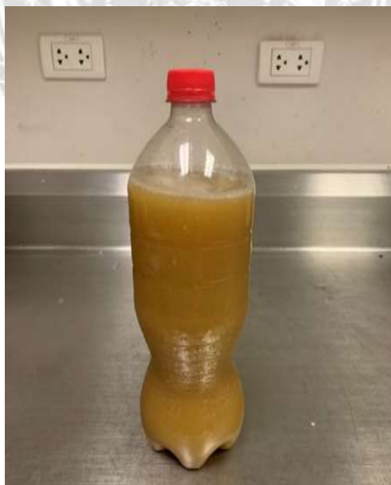
รูปที่ 4.12 ปูนํ้าจากเปลือกไข่ที่รอหมักบ่มไว้ 1 สัปดาห์
