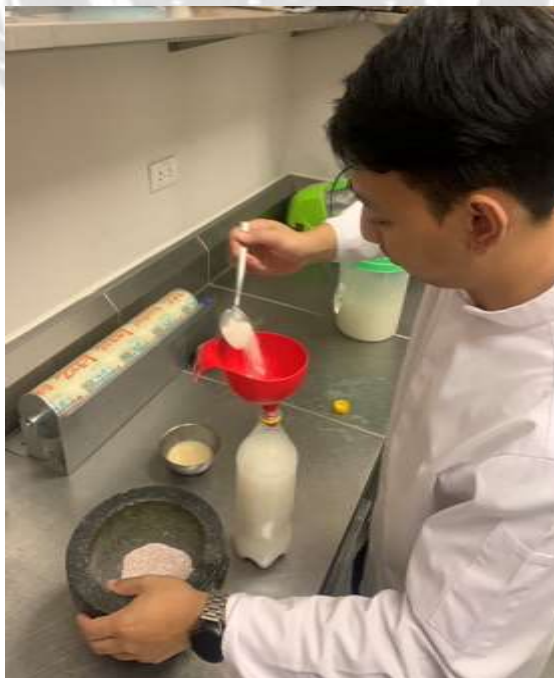
รูปที่ 4.8 นำเปลือกไข่ไก่ที่บดแล้วผสมกับน้ำข้าวข้าว ที่มา : ผู้จัดทำ (2566)
