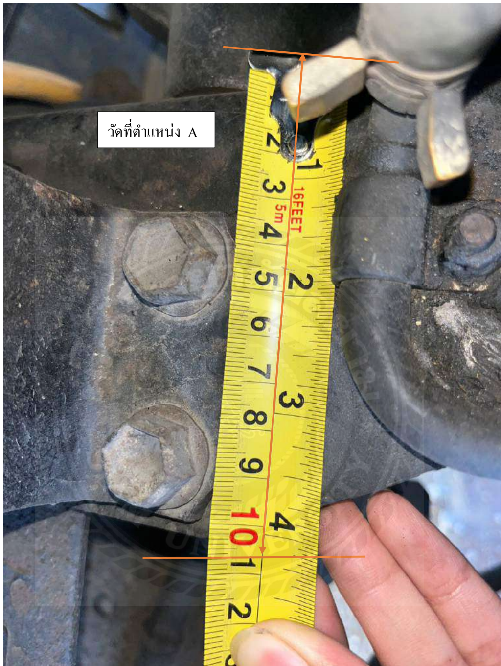
รูปที่ 4.21 ตำแหน่งการวัด โครงค้ำซีตำแหน่ง A ที่ SECTION A
