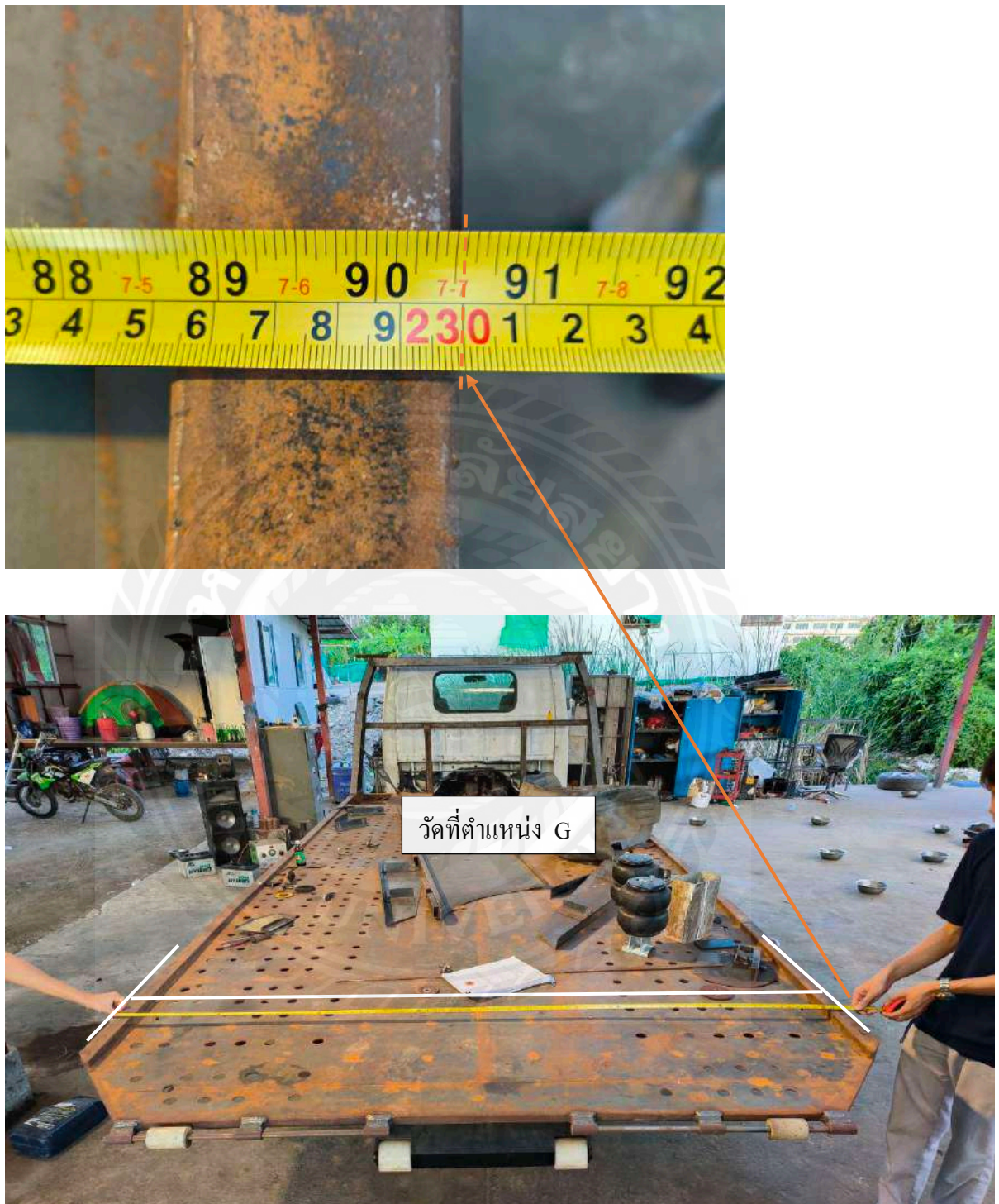
รูปที่ 4.8 ตำแหน่งวัด G ที่รถสไลด์ ISUZU NPR 150
