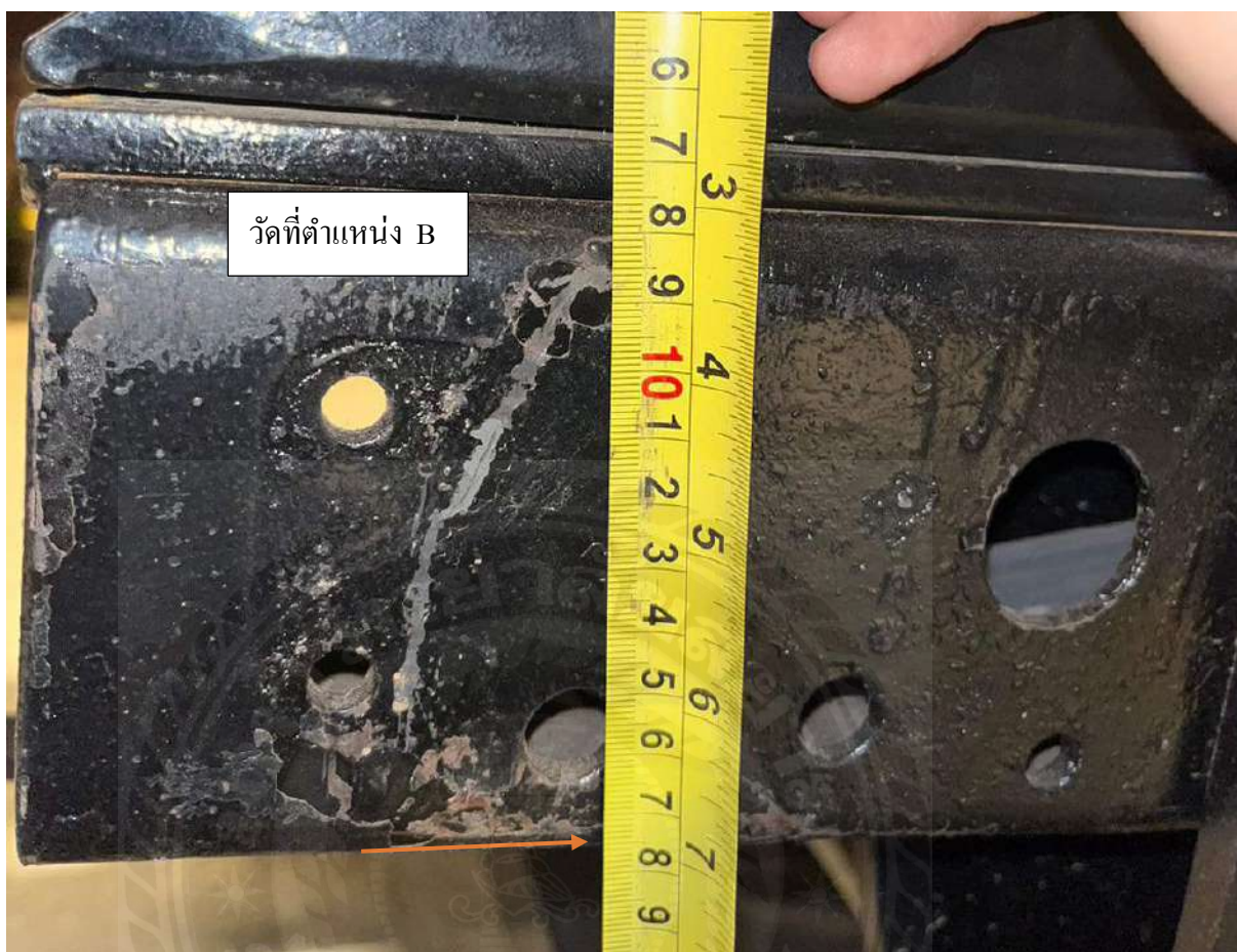
รูปที่ 4.40 ตำแหน่งการวัด โครงคัสซีตำแหน่ง B ที่ SECTION F
