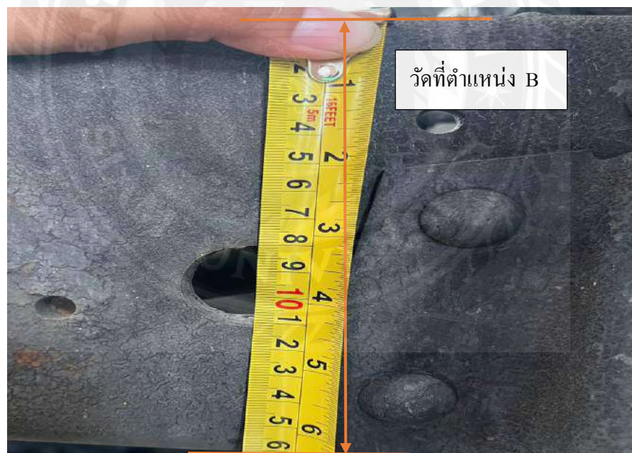
รูปที่ 4.25 ตำแหน่งการวัดโครงสร้างซีเมนต์ตำแหน่ง B ที่ SECTION B
