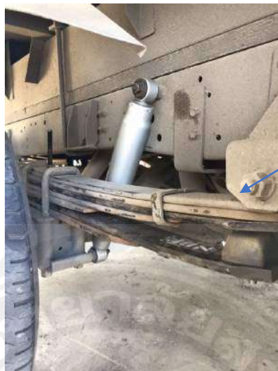
รูปที่ 3.11 แหนบสปริงของรถสไลด์ ISUZU NPR 150
