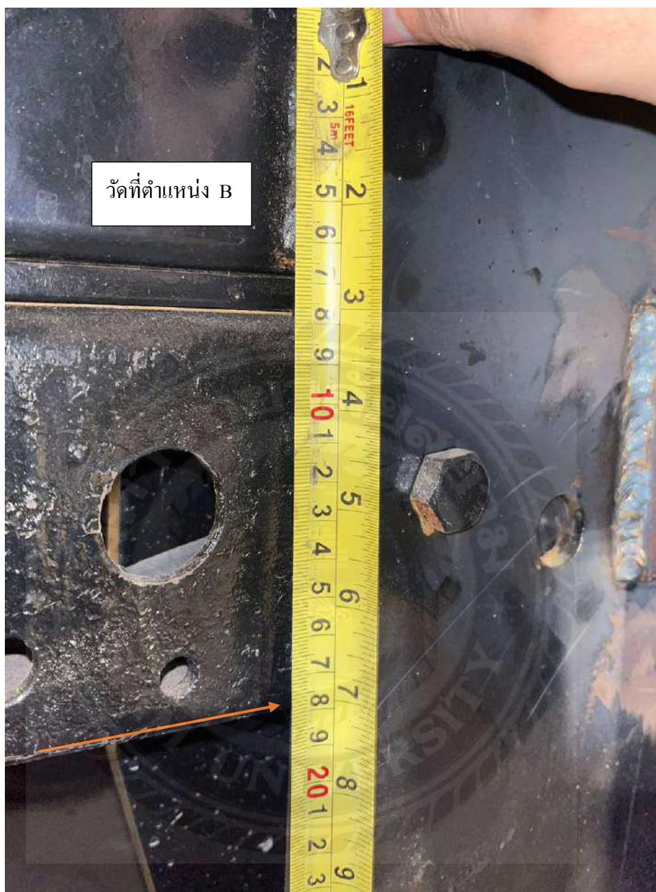
รูปที่ 4.34 ตำแหน่งการวัด โครงค้ำซีตำแหน่ง B ที่ SECTION E
