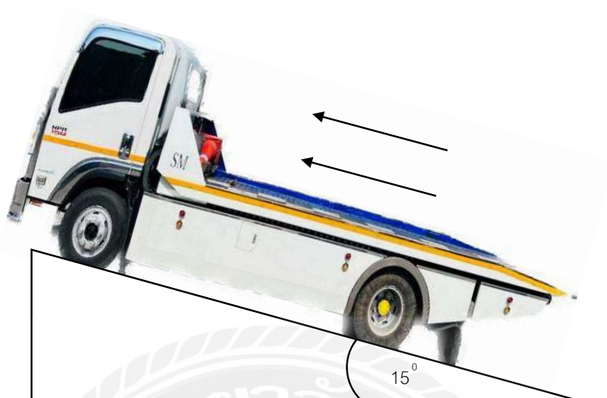
รูปที่ 4.48 รถสไลด์ ISUZU NPR 150 ขึ้นทางลาดชันมุม 15 องศา
