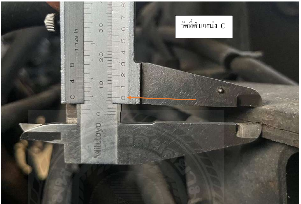
รูปที่ 4.32 ตำแหน่งการวัดโครงสร้างซีตำแหน่ง C ที่ SECTION D
