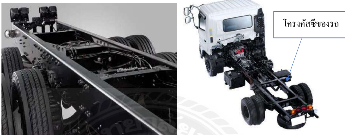
รูปที่ 3.6 โครงคัสซีของรถสไลด์ ISUZU NPR 150
