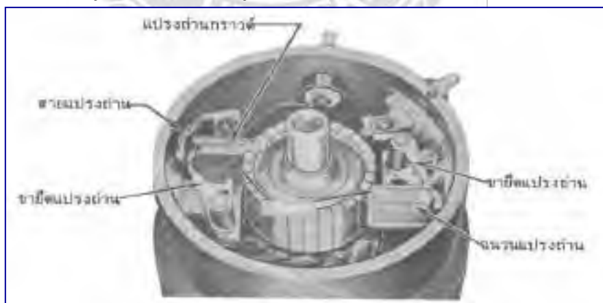
รูปที่ 2.9 แปรงถ่านถูกติดตั้งเข้ากับ โครงของเจเนอเรเตอร์
