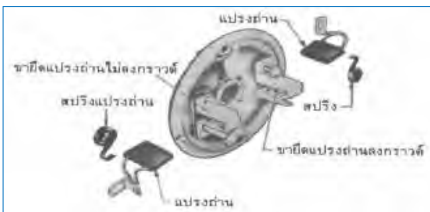
รูปที่ 2.8 ฝาท้ายของเจเนอเรเตอร์ติดตั้งแปรงถ่านเข้าด้วยกัน
