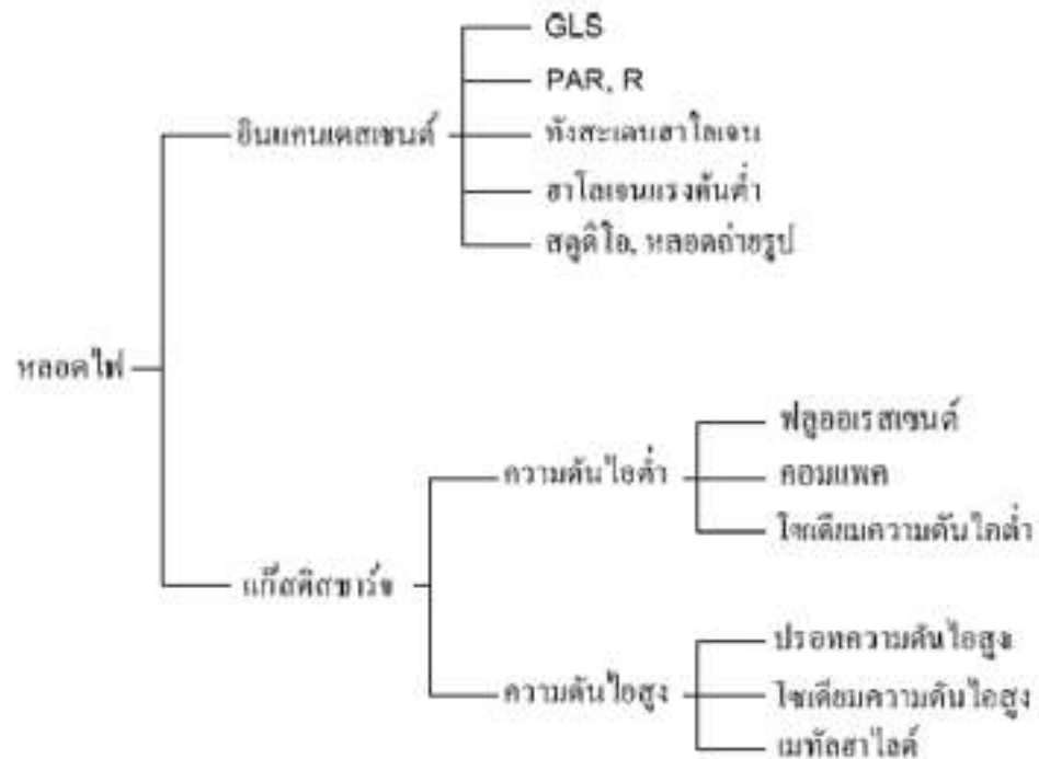
รูปที่ 2.16 แผนภาพการแบ่งชนิดของหลอดไฟ
