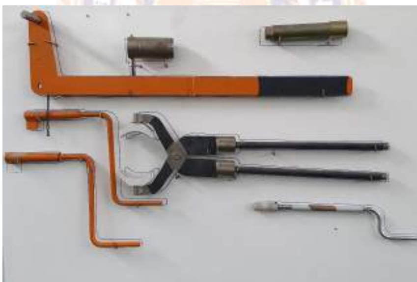
รูปที่ 2.5 เครื่องมือปลดสับ GIS แรงดัน 69 V ด้านกลไก
