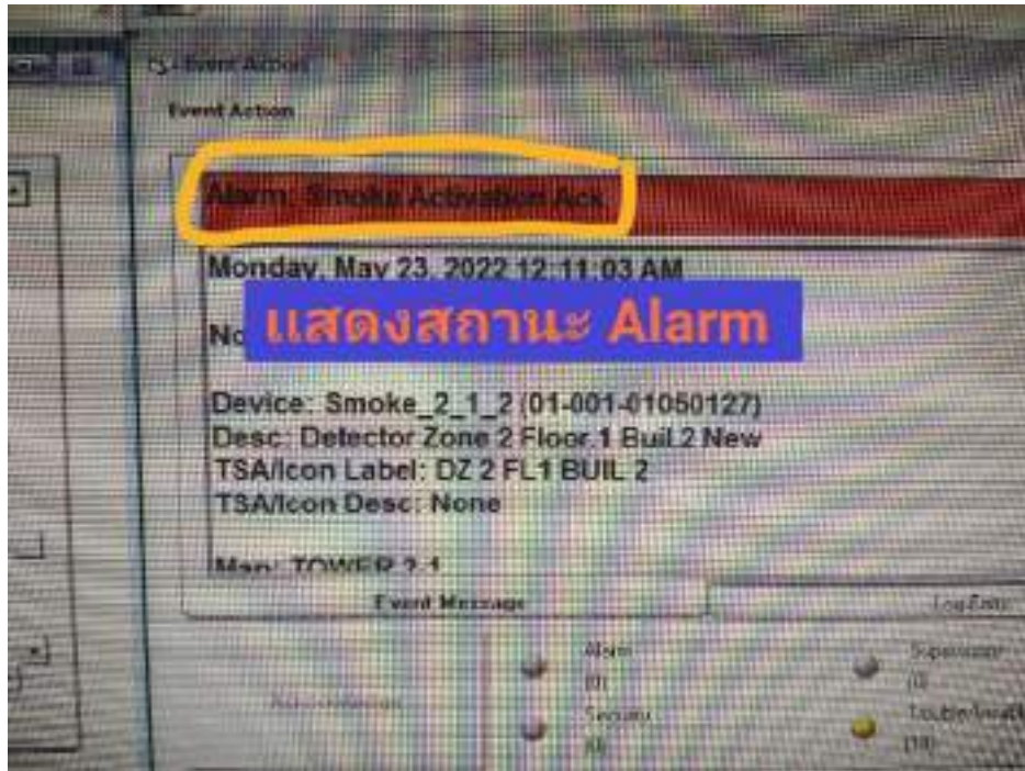
รูปที่ 4.19 ทดสอบ PC ของระบบ Fire Alarm
