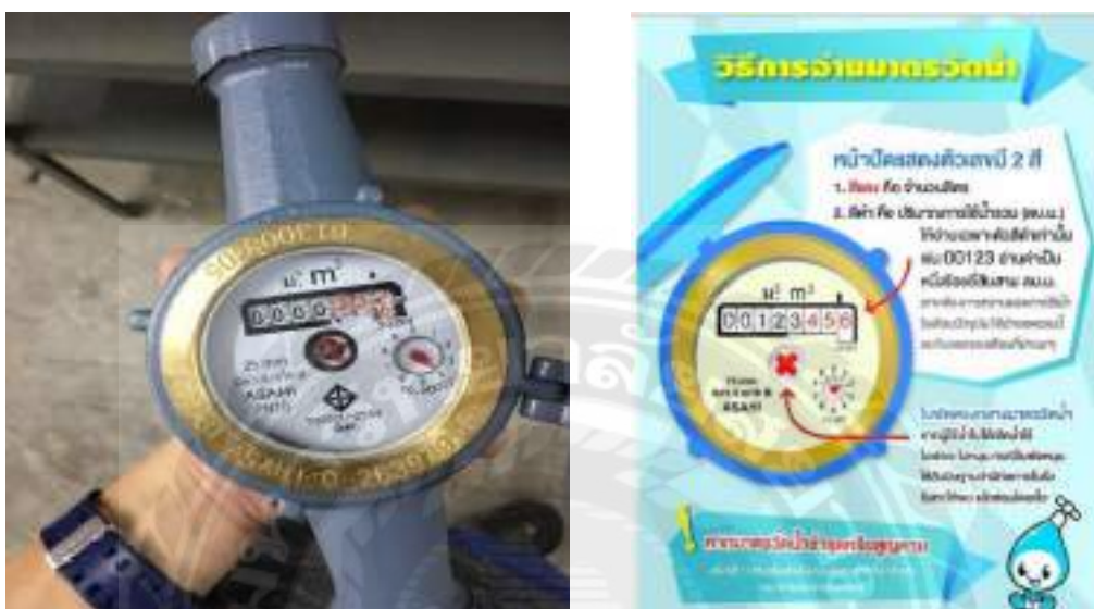
รูปที่ 4.4 หน้าปัทม์มิเตอร์น้ำและการอ่าน
