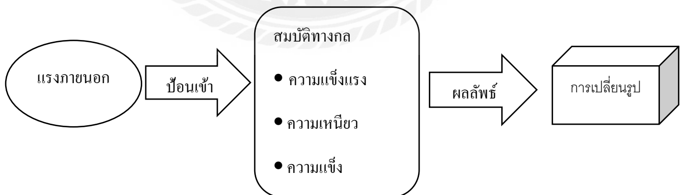
รูปที่ 2.13 สมบัติทางกลที่แสดงออกมาเมื่อวัสดุถูกแรงภายนอกกระทำ
