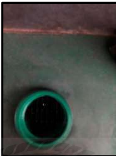
รูปที่ 3.11 ระดับน้ำกลั่นอยู่สูงจากธาตุทองแดง 10 มม.
