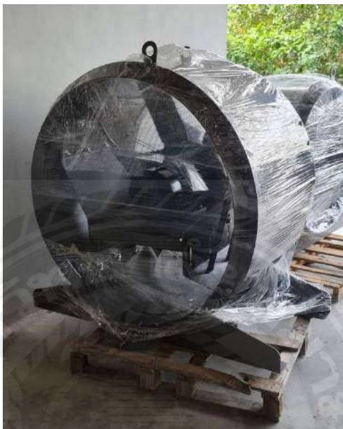
รูปที่ ข.1 ภาพด้านหน้าพัดลมอัดอากาศ
