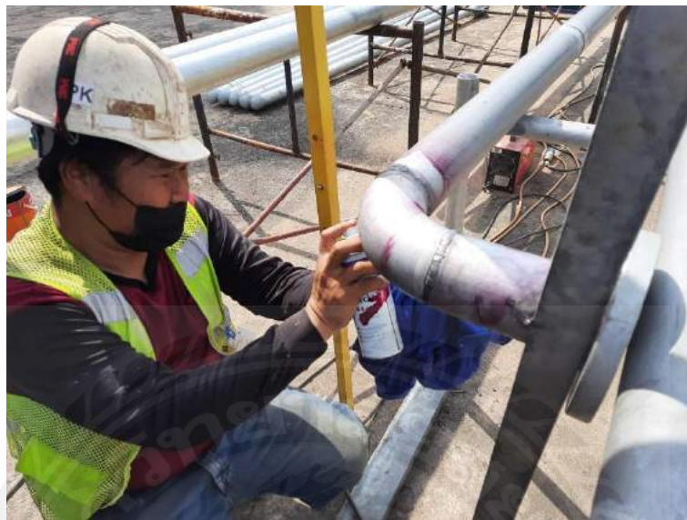
รูปที่ 3.10 ล้างคราบสีแดงบนพื้นผิวชิ้นงานออก
