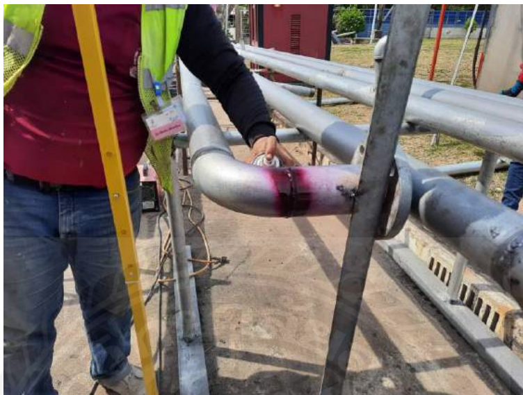
รูปที่ 3.9 ฉีดสเปรย์น้ำยาแทรกซึม บริเวณที่ตรวจสอบ
