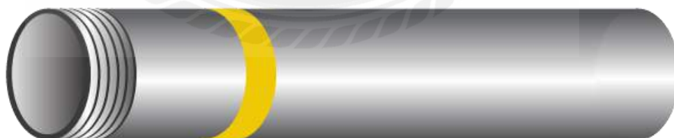
รูปที่ 2.12 ท่อกล้าไนซ์คาดเหลือง
