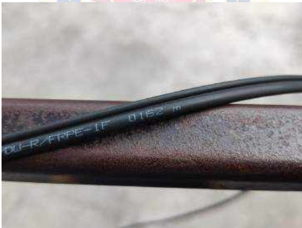
รูปที่ 3.23 เซ็ค Mark Length ปลายทาง ของสายเพื่อวิเคราะห์หาระยะทางที่เกิดปัญหา
