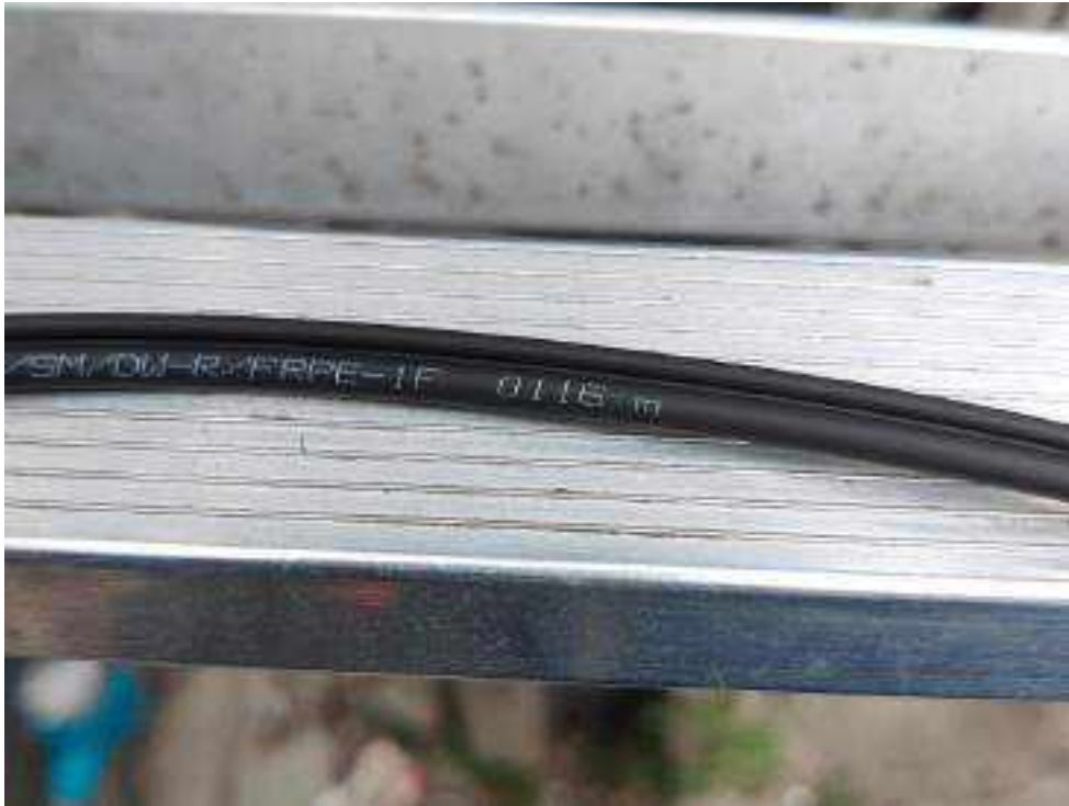
รูปที่ 3.22 เซ็ค Mark Length ต้นทาง ของสายเพื่อวิเคราะห์หาระยะทางที่เกิดปัญหา
