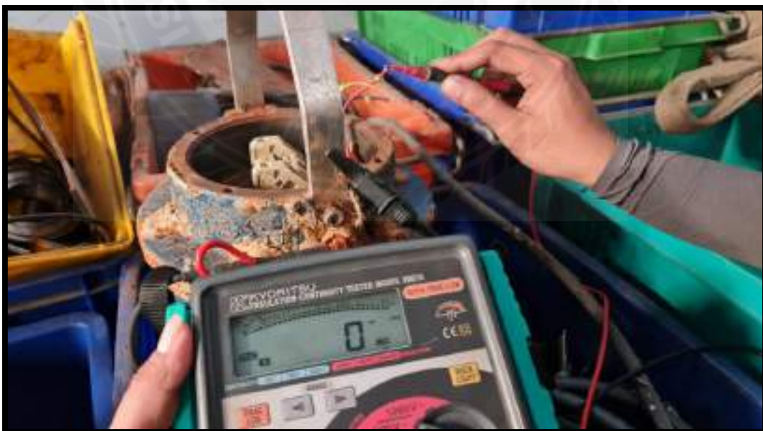
รูปที่ 4.22 ตัวอย่างการตรวจเช็คค่าความต้านทานของฉนวนที่มีปัญหาของ U-G
