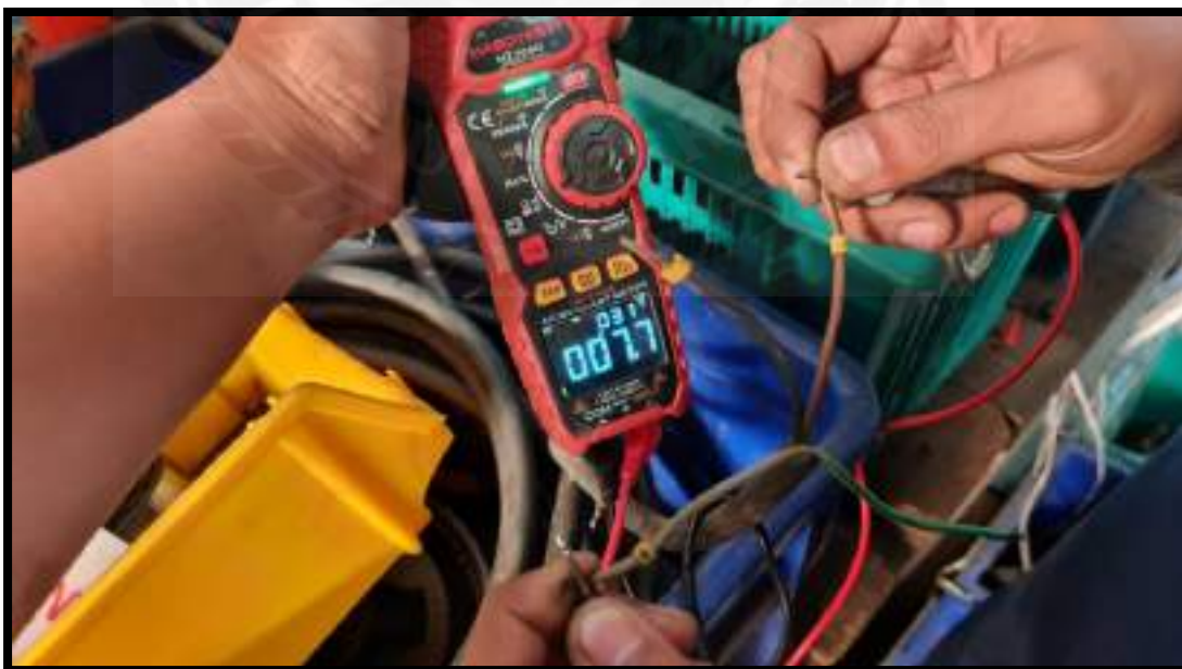
รูปที่ 4.5 การตรวจเช็คค่าความต้านทานของ U-W
