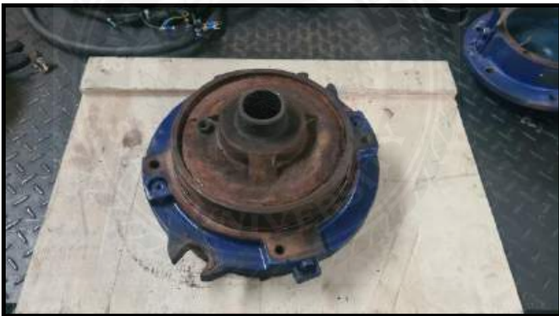
รูปที่ 4.32 ห้องน้ำมันไปหล่อหน้าseal
