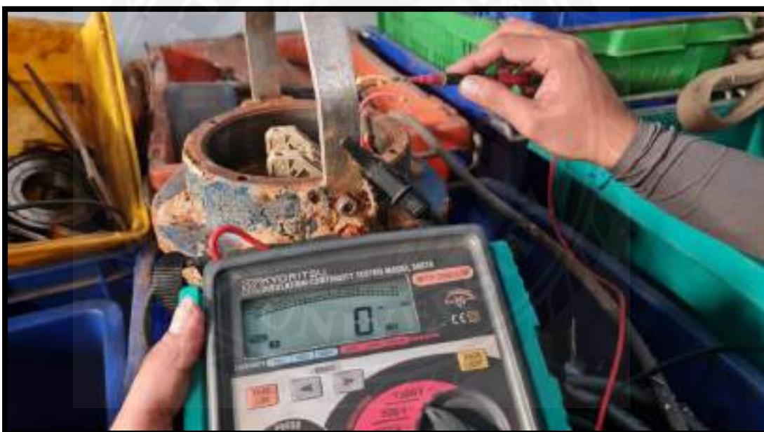
รูปที่ 4.24 ตัวอย่างการตรวจเช็คค่าความต้านทานของฉนวนที่มีปัญหาของ W-G
