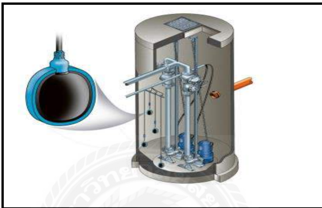
รูปที่ 4.36 ตัวอย่างการติดตั้งลูกลอย
