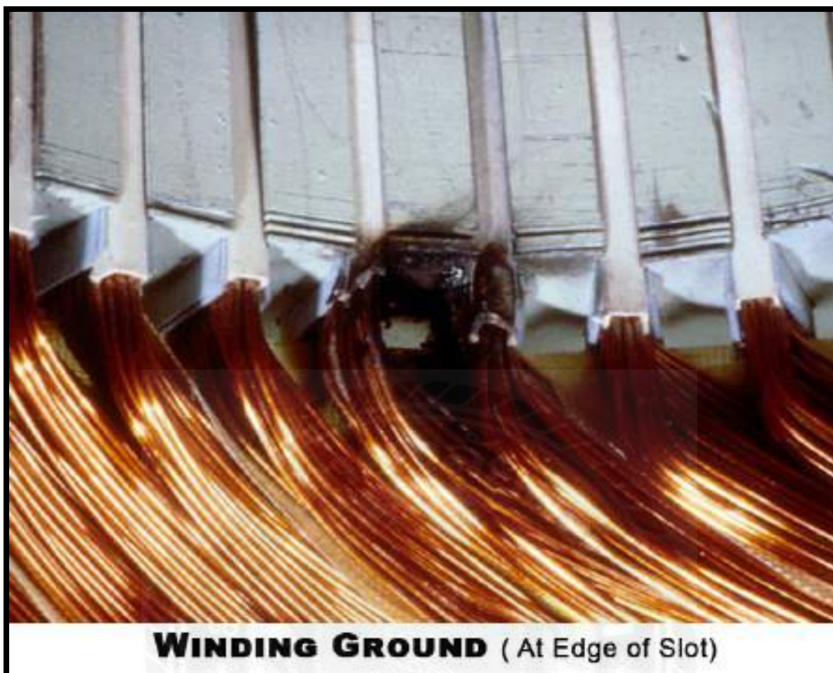
รูปที่ 2.15 ตัวอย่างขดลวดที่เกิดจากขดลวดลงกราวด์ตรงปากสล๊อต
