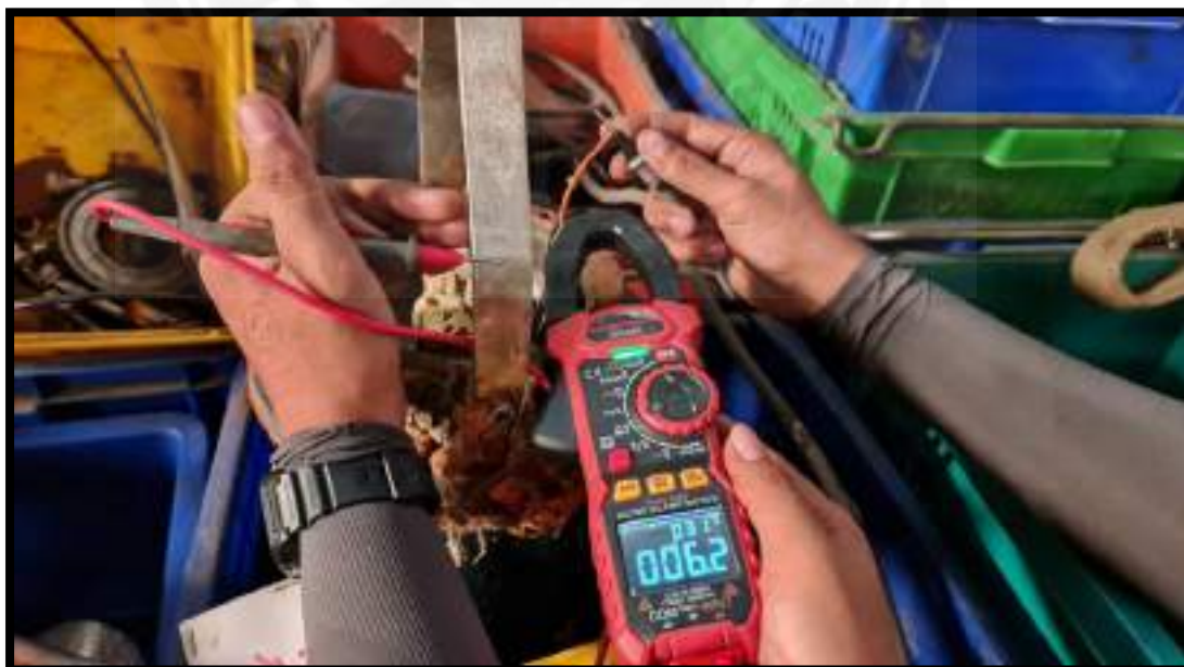
รูปที่ 4.11 การตรวจเช็คแบบเทียบกราวด์ที่มีปัญหา ขั้ว V-G
