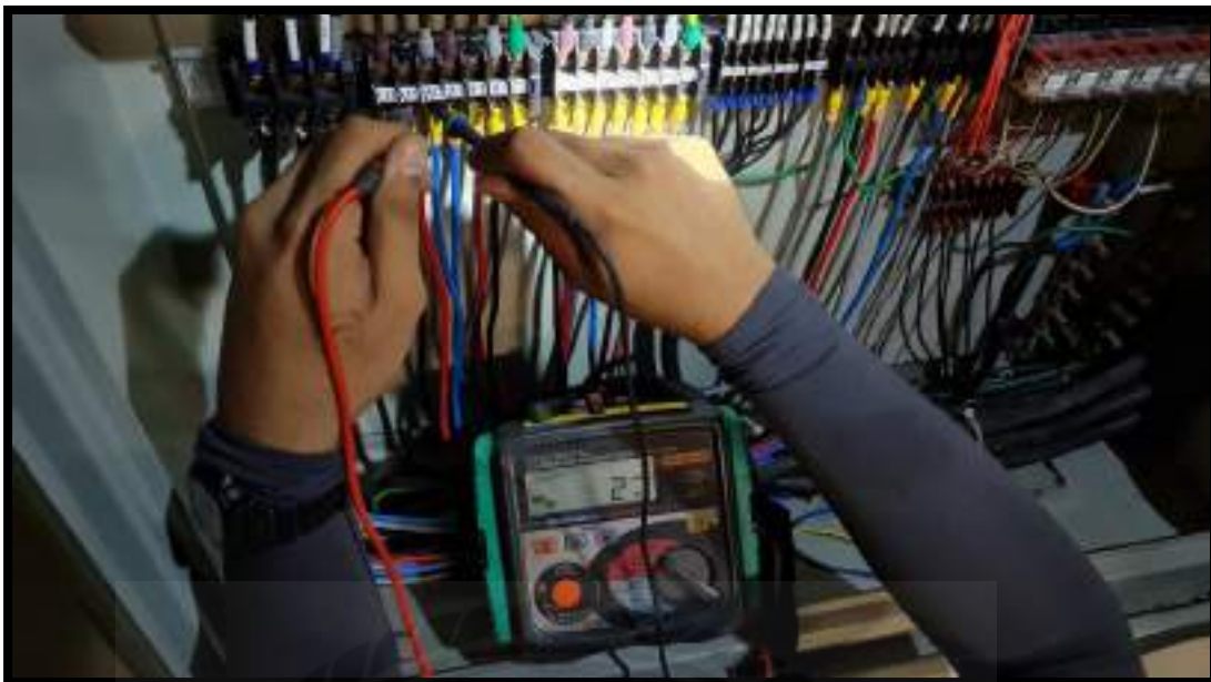
รูปที่ 4.21 ตัวอย่างการตรวจเช็คค่าความต้านทานของฉนวนของ V1-W1
