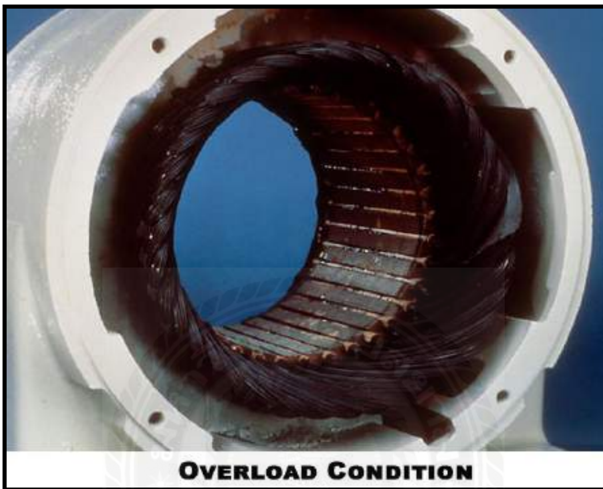
รูปที่ 2.19 ตัวอย่างขดลวดที่เกิดจากขดลวดไหม้เกิดจากการใช้งานเกินพิกัด
