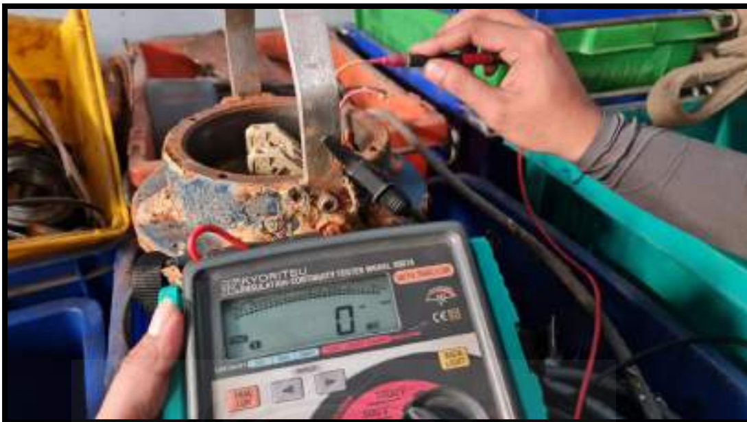
รูปที่ 4.23 ตัวอย่างการตรวจเช็คค่าความต้านทานของฉนวนที่มีปัญหาของ V-G
