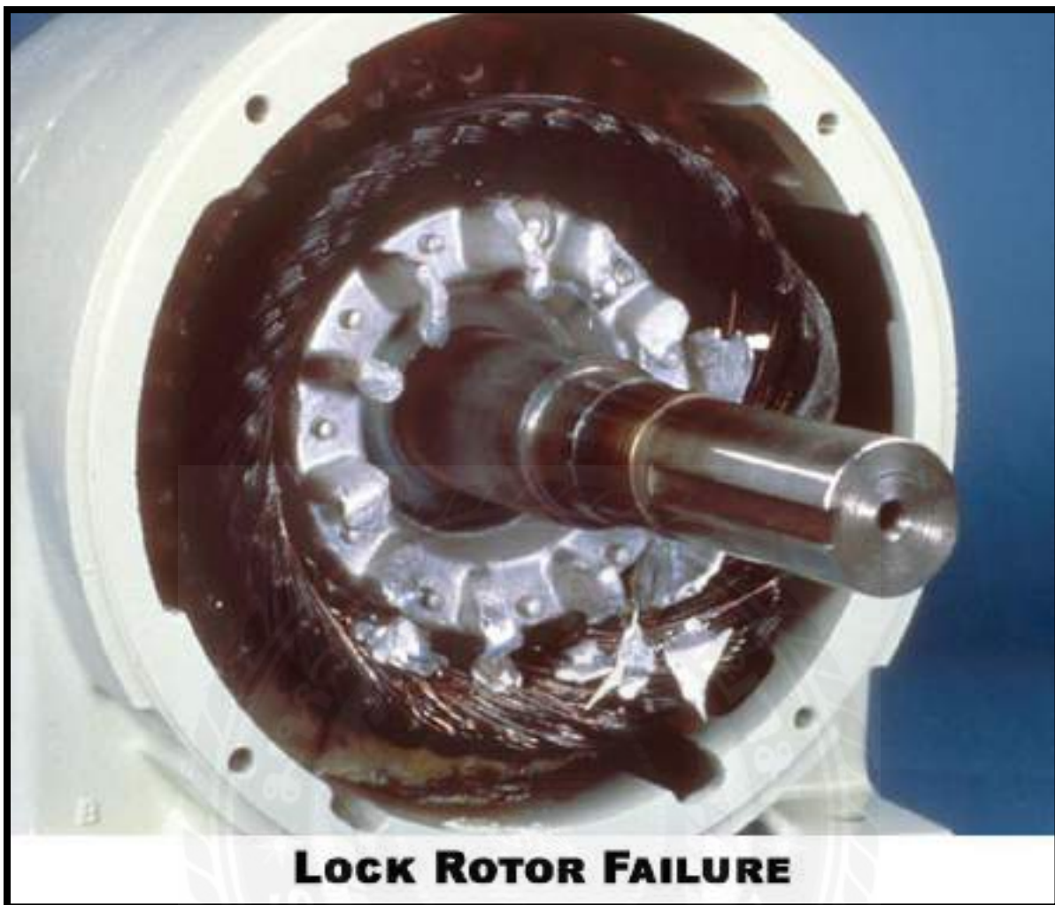
รูปที่ 2.20 ตัวอย่างความเสียหายเกิดจากรอเตอร์ล๊อค
