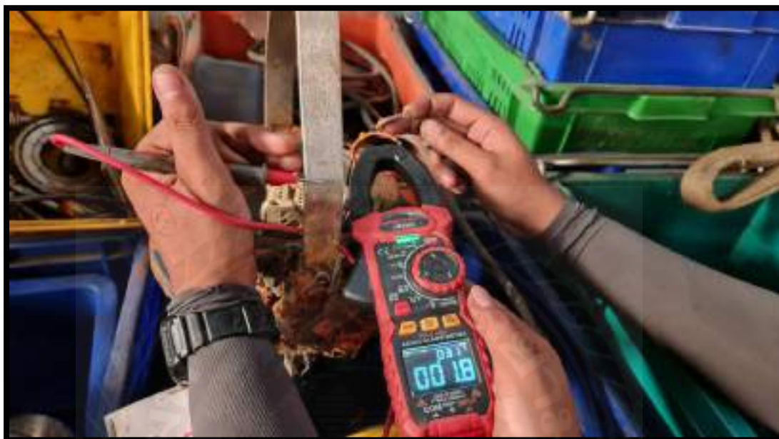
รูปที่ 4.10 การตรวจเช็คแบบเทียบกราวด์ที่มีปัญหา ขั้ว U-G
