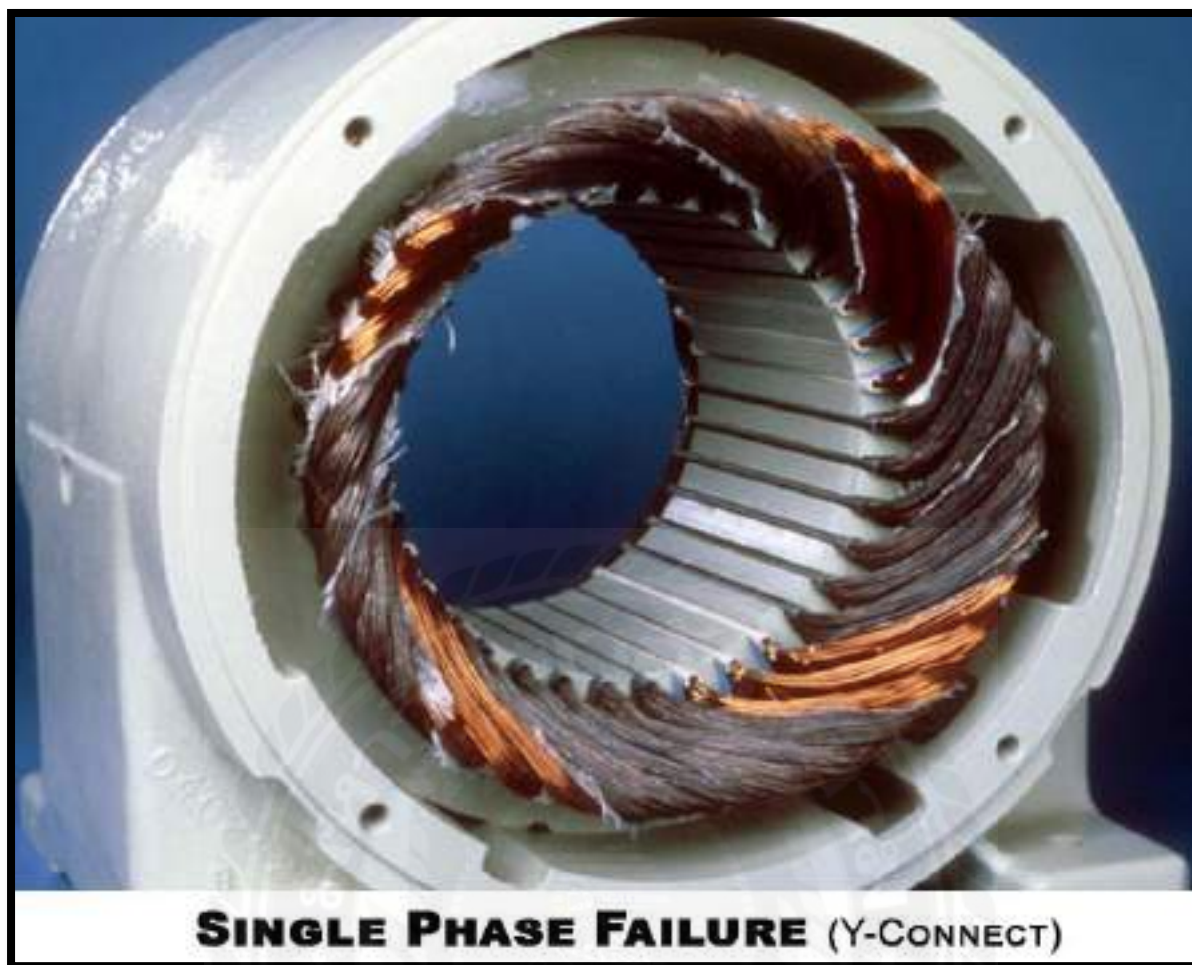
รูปที่ 2.10 ตัวอย่างขดลวดที่เกิดจากระบบไฟฟ้าขาดเฟสของการต่อแบบสตาร์
