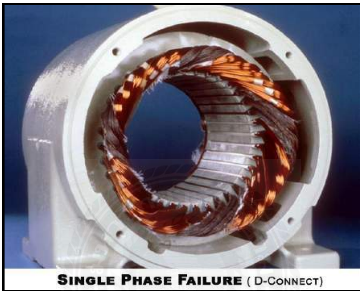
รูปที่ 2.11 ตัวอย่างขดลวดที่เกิดจากระบบไฟฟ้าขาดเฟสของการต่อแบบเดลต้า
