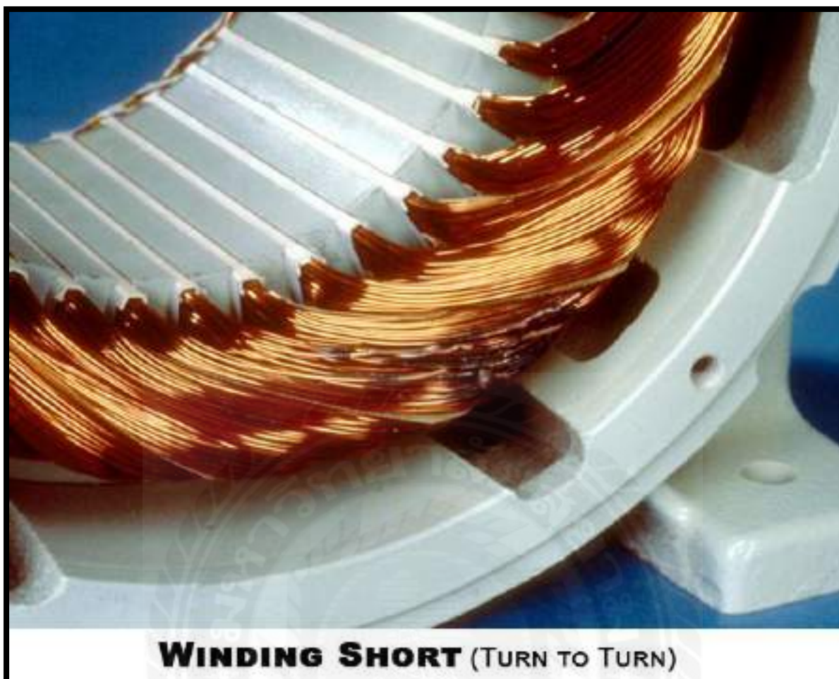
รูปที่ 2.13 ตัวอย่างขดลวดที่เกิดจากขดลวดช็อตแบบเทิร์น-เทิร์น
