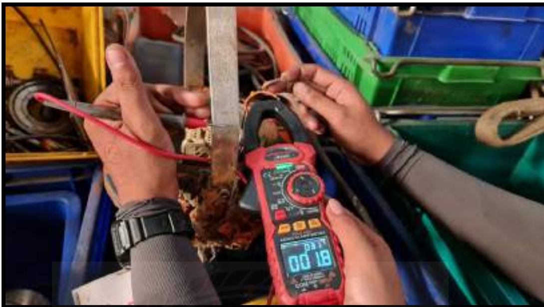
รูปที่ 4.12 การตรวจเช็คแบบเทียบกราวด์ที่มีปัญหา ขั้ว W-G
