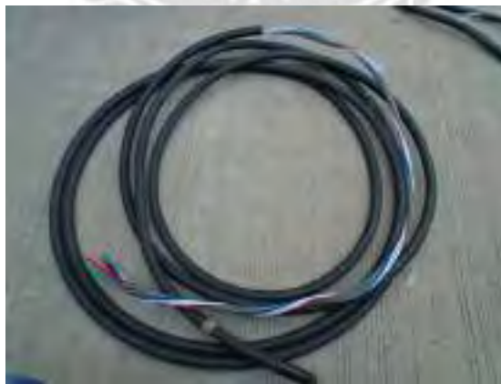
รูปที่ 4.1 สายต่อวงจรควบคุม
