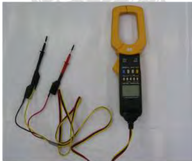
รูปที่ 2.27 Clamp on Power Meter
