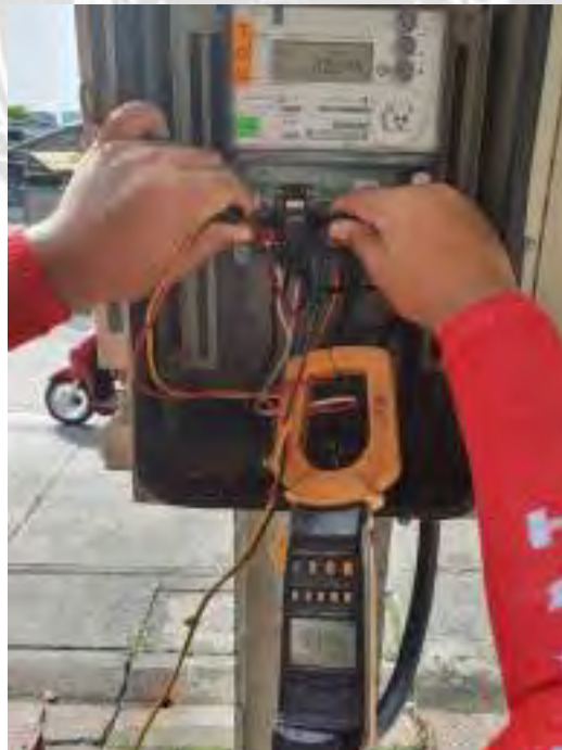
รูปที่ 9 การวัดค่ากำลังไฟฟ้าเพื่อตรวจสอบเครื่องวัดไฟฟ้า
