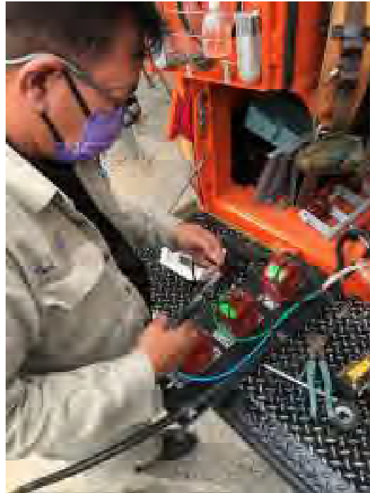
รูปที่ 4.10 การต่อวงจรของ CT
