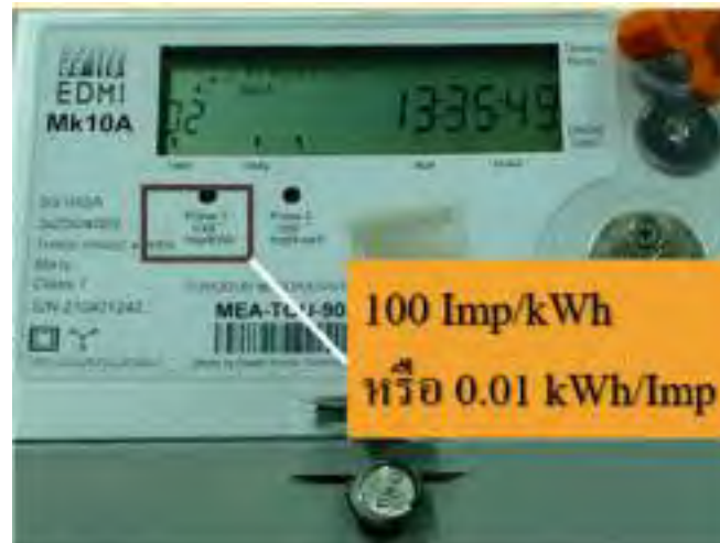
รูปที่ 2.32 ค่า Constant ของเครื่องวัดฯ รุ่น EDM1 Mk10A
