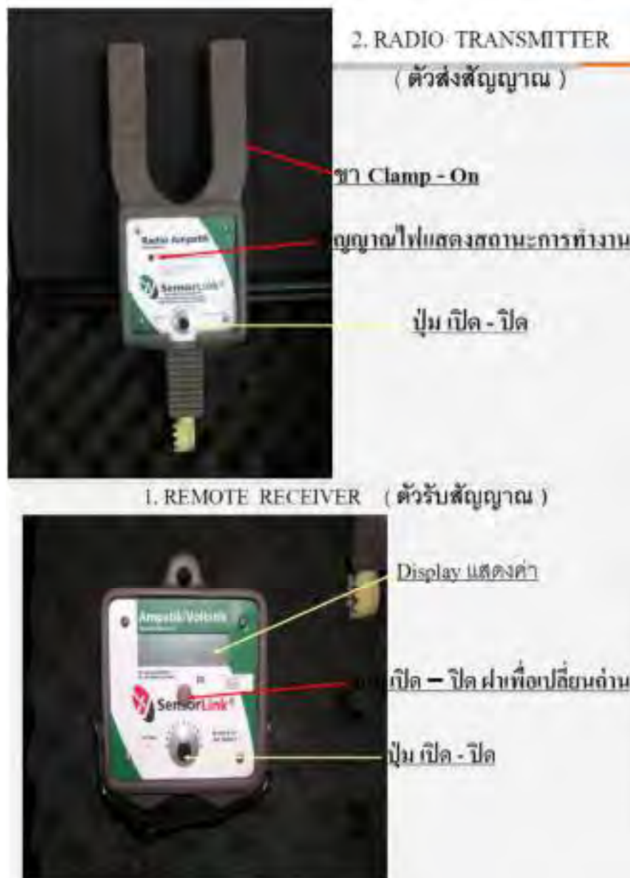
รูปที่ 2.25 Wireless Current Meter
