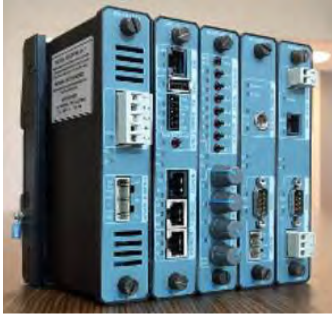
รูปที่ 2.6 Remote Terminal Unit (RTU)
