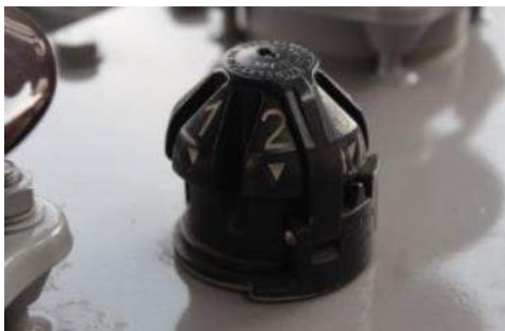
รูปที่ 4.6 อุปกรณ์ปรับเปลี่ยนระดับแรงดัน
