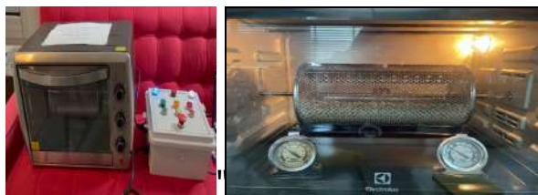
รูปที่ 2 เครื่องคั่วเมล็ดกาแฟที่ดัดแปลงจากเตาอบไฟฟ้า
