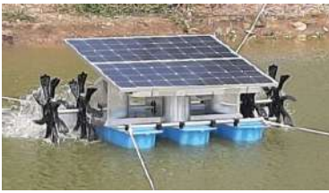
รูปที่ 9 เครื่องกังหันน้ำเติมอากาศพลังงานแสงอาทิตย์ที่สร้างขึ้น
