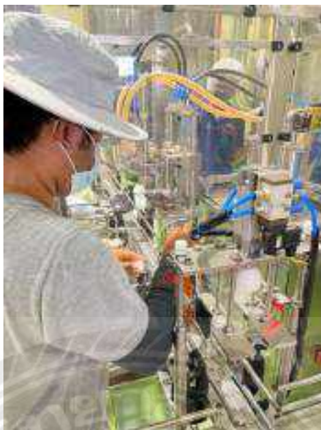
รูปที่ 2.3 เป็นการเข้าซ่อมแซมเครื่องผลิตซอสหอยชนิดขวดใหญ่
