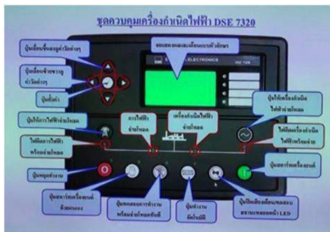
รูปที่ 2.43 ชุดควบคุมเครื่องกำเนิดไฟฟ้า
