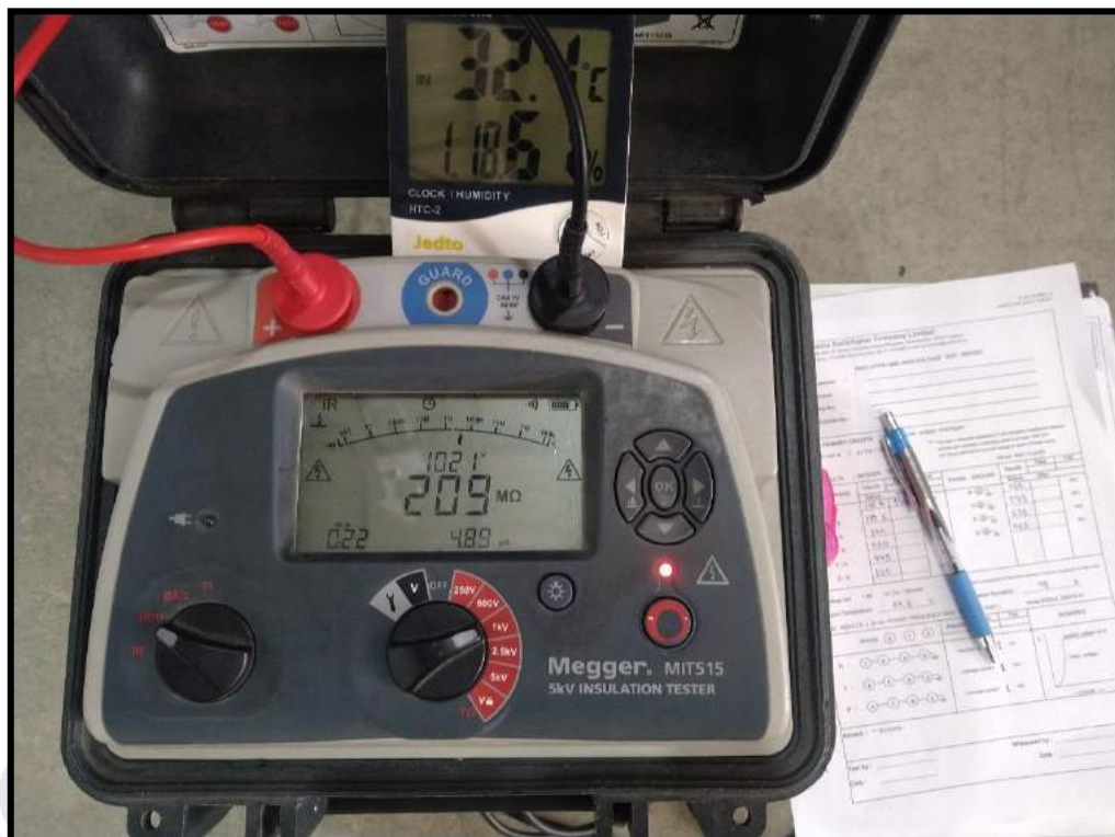
การทดสอบความเป็นฉนวนทางไฟฟ้า
