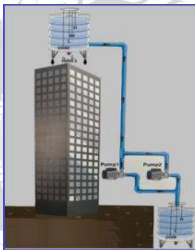
รูปที่ 2.3 รูปแสดงการควบคุมปั้มน้ำแบบ Transfer Pump
