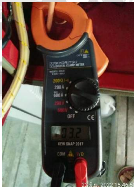
รูปที่ 4.2.5 วัดค่าความต้านทานและวัดกระแสไฟฟ้า
