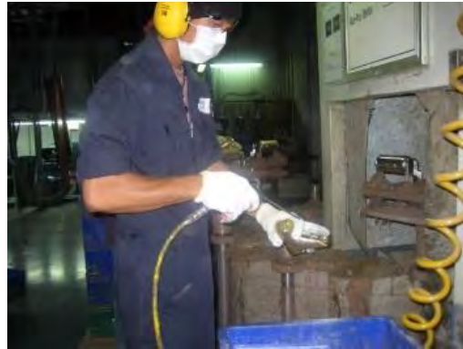
รูปที่ ข24 การเป่าลมชิ้นงาน
