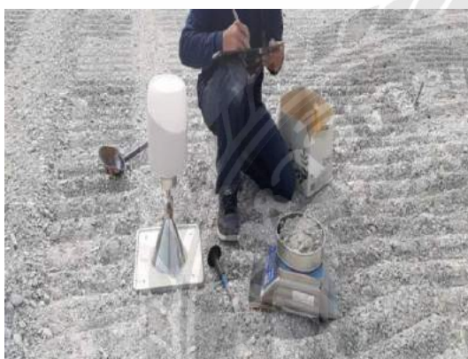
(ก) วัสดุพื้นทางเมื่อทดสอบความหนาแน่นในสนาม (ข) วัสดุพื้นดินถมเมื่อทดสอบความหนาแน่นในสนามแล้วไม่ได้ค่าตามที่กำหนดไว้ในแบบ
