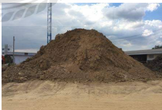
(ง) วัสดุดินถมกันมีค่า CBR ไม่ได้ตามแบบ
