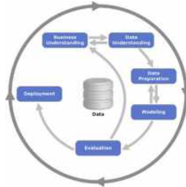
ภาพที่ 2.1 ขั้นตอนการดำเนินงานตามแบบ CRISP-DM
