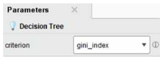
ภาพที่ 3.6 ขั้นตอนการปรับพารามิเตอร์ Criterion เป็น gini index
