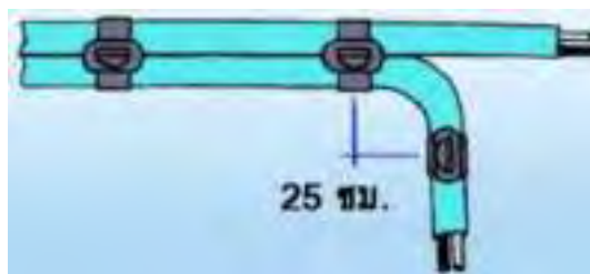
รูปที่ 2.27 การหักมุมโค้ง สาย VAF ขนาด 2 X 2.5 (ตร.มม.)
