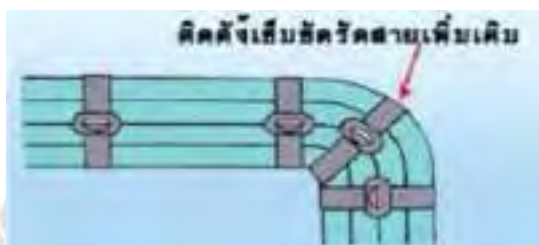
รูปที่ 2.28 การติดตั้งเข็มขัดรัดสายตามมุมโค้งเมื่อต้องโค้งสายหลายๆเส้น
