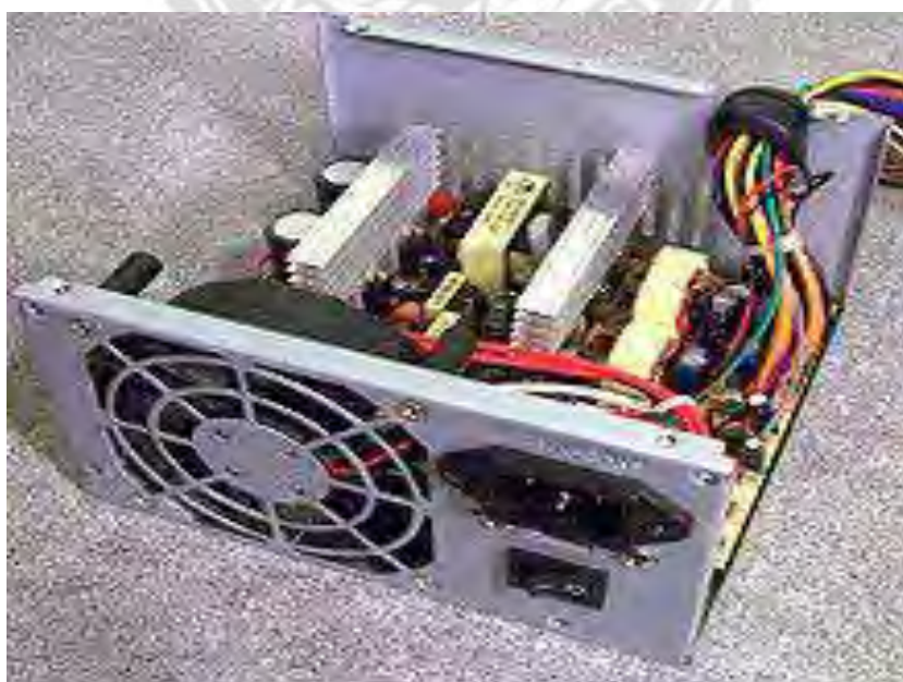
รูปที่ 2.4 ชุดจ่ายไฟ (Power Supply)
