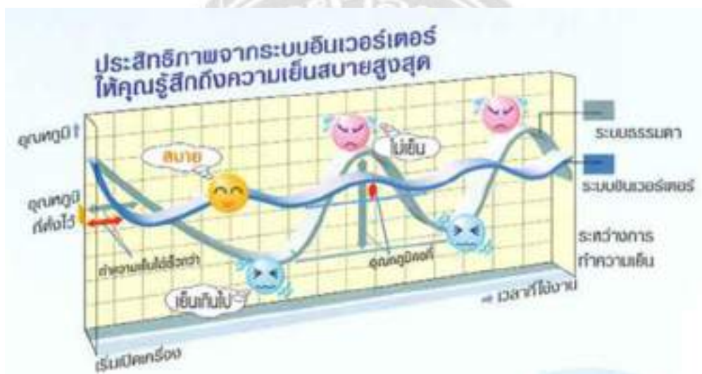
รูปที่ 2.27 ประสิทธิภาพระบบอินเวอร์เตอร์ในระบบปรับอากาศ
