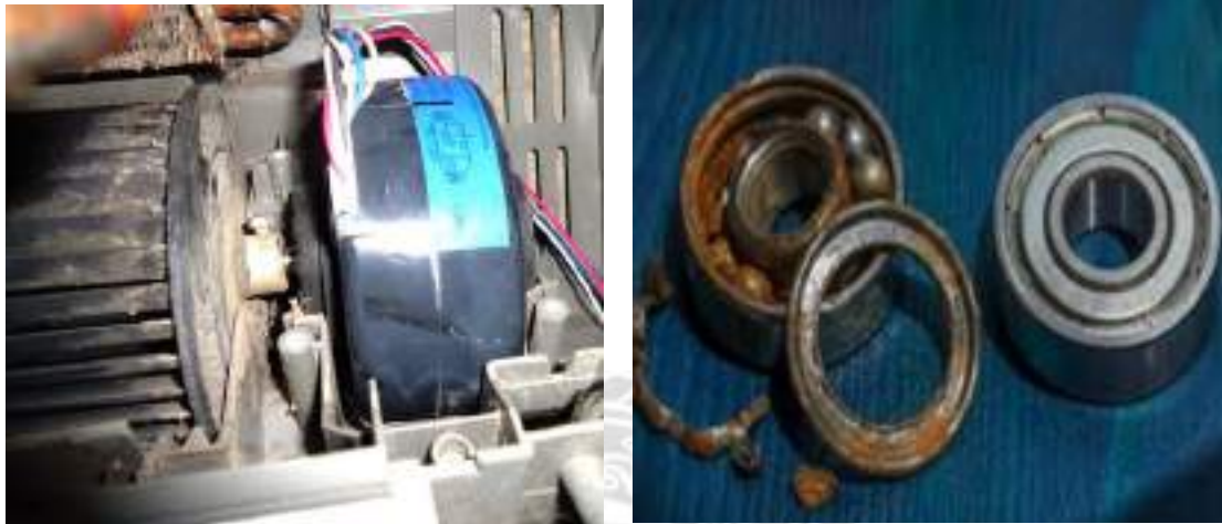
รูปที่ 4.8 แอร์มีเสียงดังที่เกิดจากมอเตอร์แฟนคอยล์
