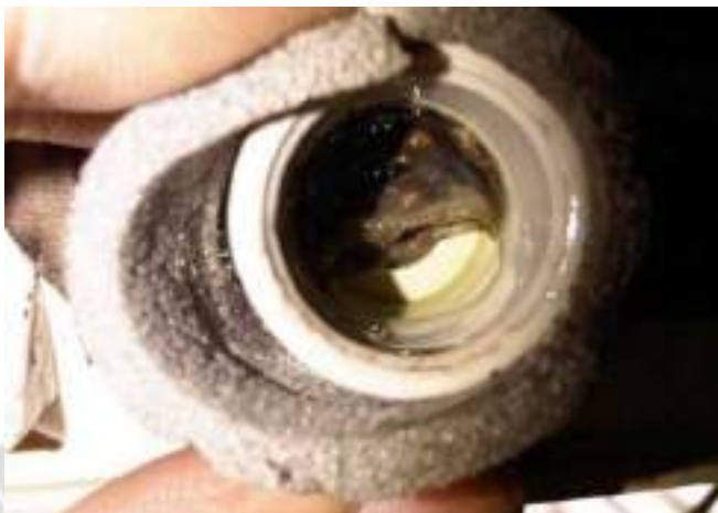
รูปที่ 4.2 สาเหตุที่แอร์น้ำหยดจากการที่มีสิ่งอุดตัน
