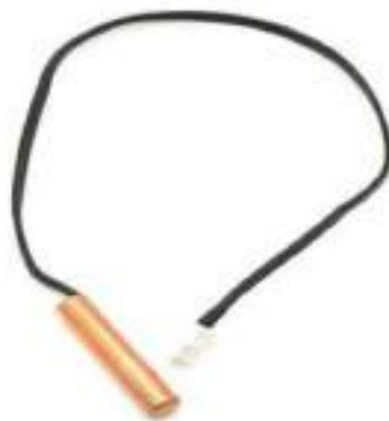
รูปที่ 4.5 เซ็นเซอร์วัดอุณหภูมิแอร์เสีย
