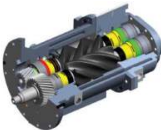
รูปที่ 2.6 คอมเพรสเซอร์แบบสกรู ( Screw Type )
