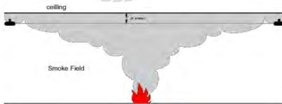
รูปที่ 2.23 อุปกรณ์ตรวจจับควัน แบบลำแสง ( Projected Beam Detector )
