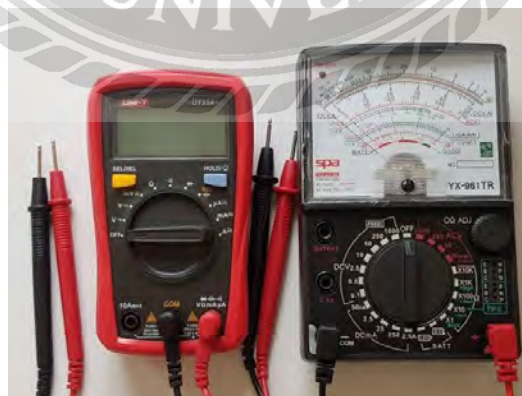
รูปที่ 3.15 มัลติมิเตอร์ ( Multimeter )
