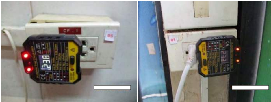
รูปที่ 4.31 สาย L กับสาย N สลับกัน
