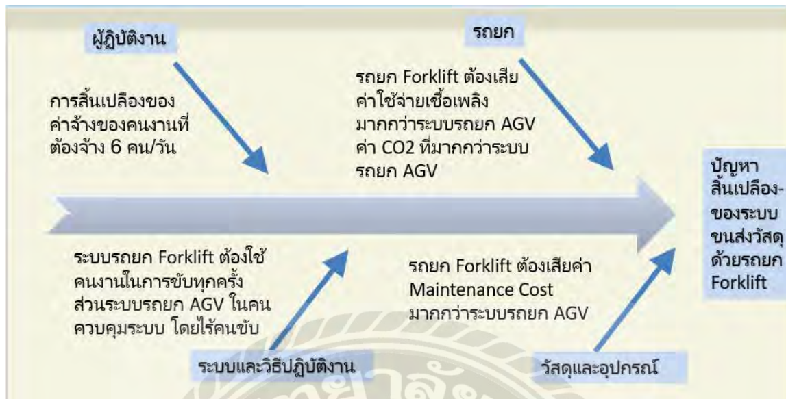
รูปที่ 4.5 การวิเคราะห์สภาพปัญหาจากการใช้รถยกโดยใช้แผนภูมิแกงปลา
