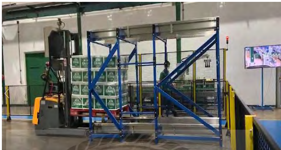
รูปที่ 4.14 รถ AGV เคลื่อนที่จากระบบการควบคุมนำทางจนมาถึงหน้าสายพานลำเลียง
