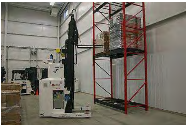
รูปที่ 2.7 รถยก AGV อัตโนมัติเต็มรูปแบบการหยิบโหลดจากชั้นวาง
