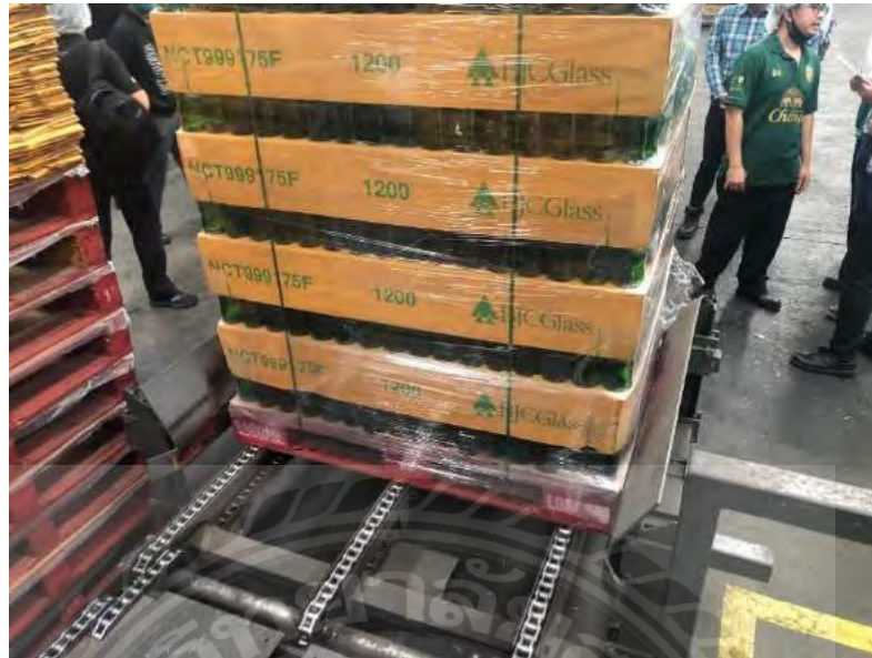
รูปที่ 4.12 ทดสอบระบบสายพานลำเลียงหลังจากติดตั้งแล้วเสร็จ
