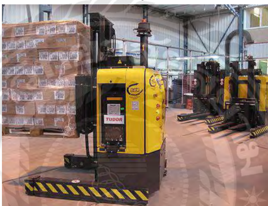
รูปที่ 2.8 AGV มีขนาดเล็กและใช้สำหรับการหลบหลีกในพื้นที่ขนาดเล็ก
