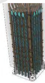
รูปที่ 4.40 โมเดล 3 มิติ แสดงการใช้ Column Shoes + Corrugated เสาโครงสร้าง
